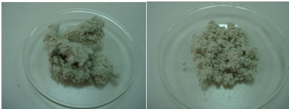
Εικόνα 27: Δείγμα χρυσοτιλικού αμιάντου πριν και μετά την λειοτρίβηση.
