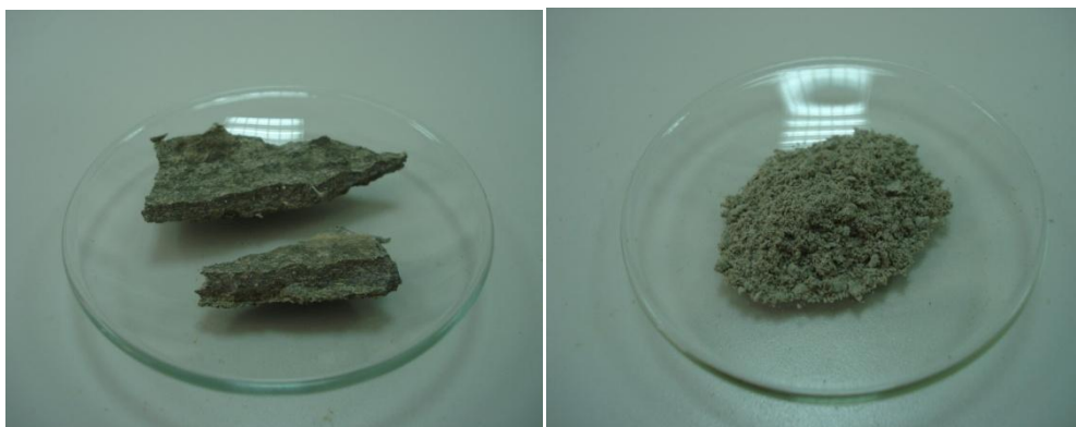
Εικόνα 28: Δείγμα αμιαντοτσιμέντου πριν και μετά την λειοτρίβηση σε μαχαιρόμυλο.
