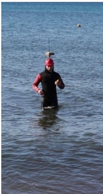
Εικόνα 7 Τοπογραφική αποτύπωση με το σύστημα RTK GPS διακρίνεται ο δέκτης του συστήματος με τον χείριστή, Βαρκίζα 2013
