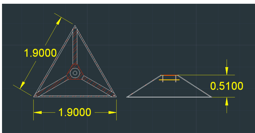
Εικόνα 10 Βάση στήριξης υποθαλάσσιου οργάνου (σχέδιο Autocad)
