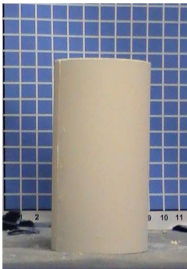
Εικόνα 4.26: Δοκιμιο D9 πριν τη μονοαξονική θλίψη
