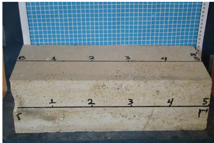
Εικόνα 3.4β: Ογκοτεμάχιο πωρόλιθου Π2 με χαραγμένες τις περιοχές μέτρησης των ταχυτήτων των διαμήκων κυμάτων. Ο κάναβος έχει διάσταση κυψέλης 1\text{ cm}^2 . Φαίνονται οι πλευρές Β και Γ.
