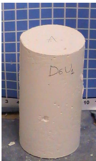
Εικόνα 4.24: Δοκιμιο D6U πριν τη μονοαξονική θλίψη.
