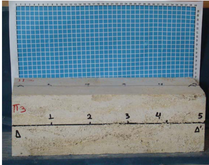
Εικόνα 3.4γ: Ογκοτεμάχιο πωρόλιθου Π3 με χαραγμένες τις περιοχές μέτρησης των ταχυτήτων των διαμήκων κυμάτων. Ο κάναβος έχει διάσταση κυψέλης 1\text{ cm}^2 . Φαίνονται οι πλευρές Α και Δ.
