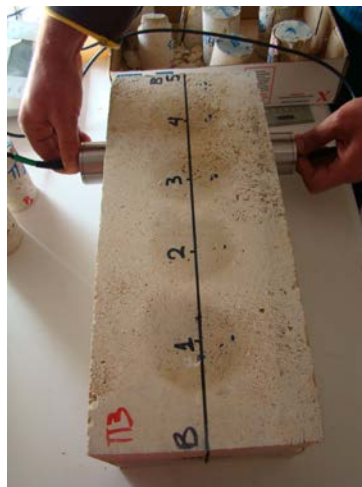
Εικόνα 3.2: Μετρήσεις ταχύτητας των διαμήκων κυμάτων με χρήση της άμεσης μεθόδου στο ογκοτεμάχιο του πετρώματος Α.
