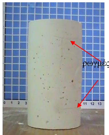
Εικόνα 4.15: Ρωγμές και πόροι στην επιφάνεια ενός κονιάματος εξαιτίας των σφικτήρων και της δόνησης.
