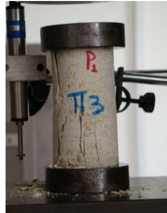
Εικόνα 3.14β: Δοκίμιο μετά τη δοκιμή μονοαξονικής θλίψης
