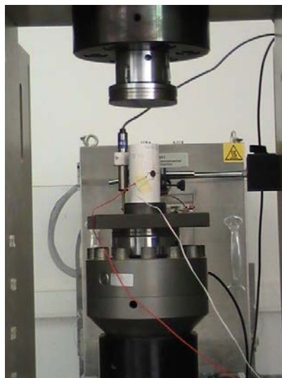
Εικόνες 4.30: Δοκίμιο D37 με ηλεκτρικά μηχανοσκόμμετρα στη μηχανή μονοαξονικής θλίψης
