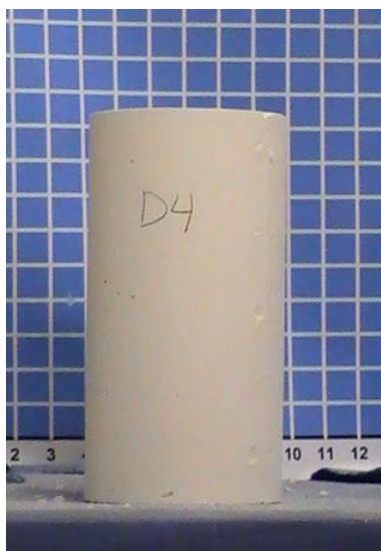
Εικόνες 4.40: Δοκίμιο D4 πριν την τριαξονική δοκιμή
