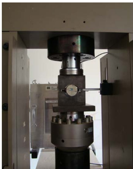
Εικόνα 3.17α: Δοκίμιο κατά τη διάρκεια της δοκιμής έμμεσου εφελκυσμού
