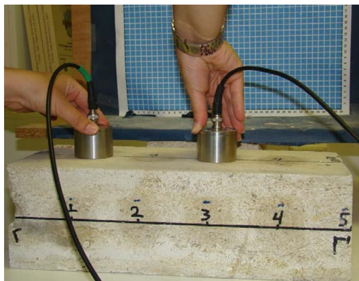
Εικόνα 3.3: Μετρήσεις ταχύτητας των διαμήκων κυμάτων με χρήση της έμμεσης μεθόδου στο ογκοτεμάχιο του πετρώματος Α.
