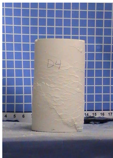
Εικόνες 4.40: Δοκίμιο D4 πριν την τριαξονική δοκιμή
