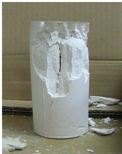
Εικόνα 4.24: Δοκιμιο D6U πριν τη μονοαξονική θλίψη.
