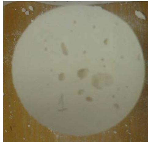
Εικόνα 4.23: Μεγάλοι πόροι στην βάση κονιάματος
