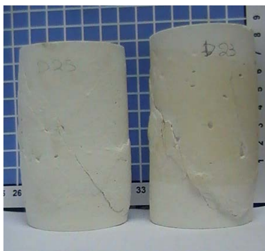
Εικόνα 4.45: Δοκίμια D23 και D25 μετά την τριαξονική τους καταπόνηση.
