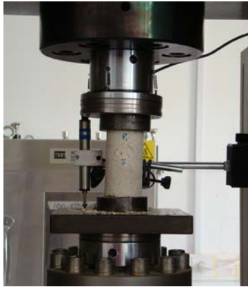
Εικόνα 3.14α: Δοκίμιο κατά τη διάρκεια της δοκιμής μονοαξονικής θλίψης
