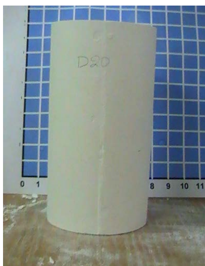
Εικόνα 4.42: Δοκίμιο D20 πριν την τριαξονική καταπόνηση
