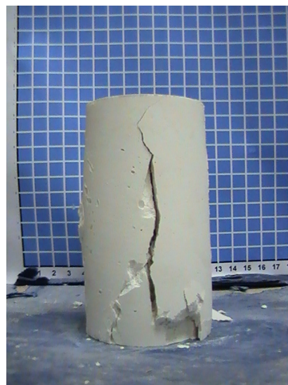
Εικόνα 4.27: Δοκιμιο D9 μετά τη δοκιμή μονοαξονικής θλίψης
