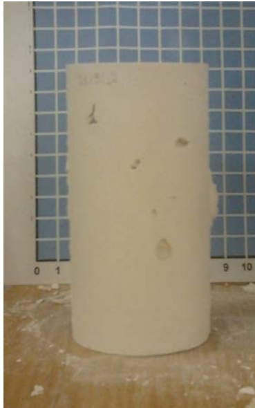
Εικόνα 4.22: Μεγάλοι πόροι στην εξωτερική επιφάνεια κονιάματος
