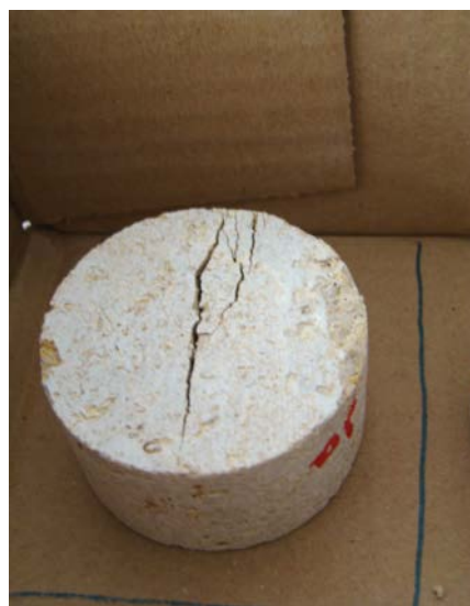
Εικόνα 3.17β: Δοκίμιο μετά τη δοκιμή έμμεσου εφελκυσμού
