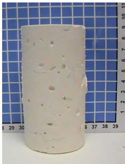
Εικόνα 4.21: Δοκίμιο που χυτεύθηκε σε μήτρα που δε λιπάνθηκε
