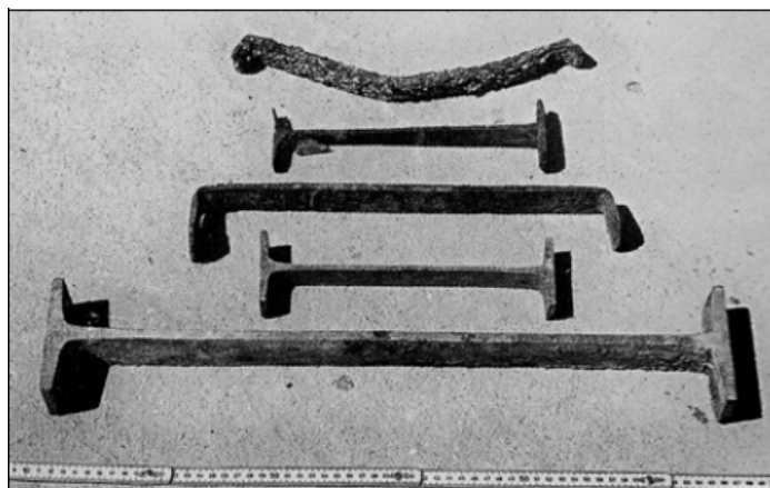
Εικόνα 2.9: Συνδετήρια στοιχεία διαφόρων σχημάτων και διατομών της επέμβασης Μπαλάνου (Παπασταματίου, 2009)
