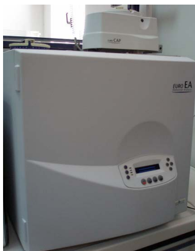
Εικόνα 3.1.1. Αυτόματος στοιχειακός αναλυτής EuroVector, Elemental Analysis CHNS-O
