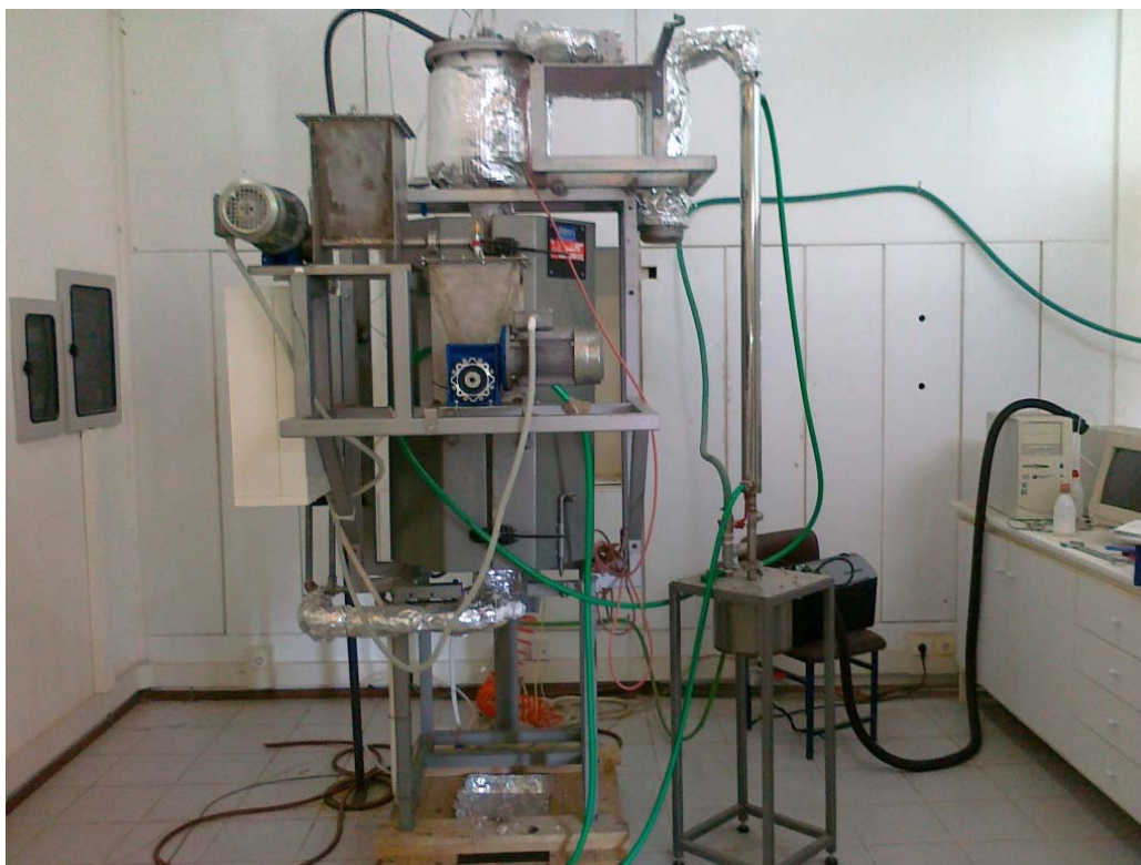
Εικόνα 3.2.1 Πειραματικός αντιδραστήρας ρευστοποιημένης κλίνης
