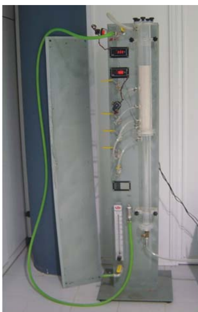
Εικόνα 3.3.1: Πειραματική διάταξη προσομοίωσης αντιδραστήρα ρευστοποιημένης κλίνης
