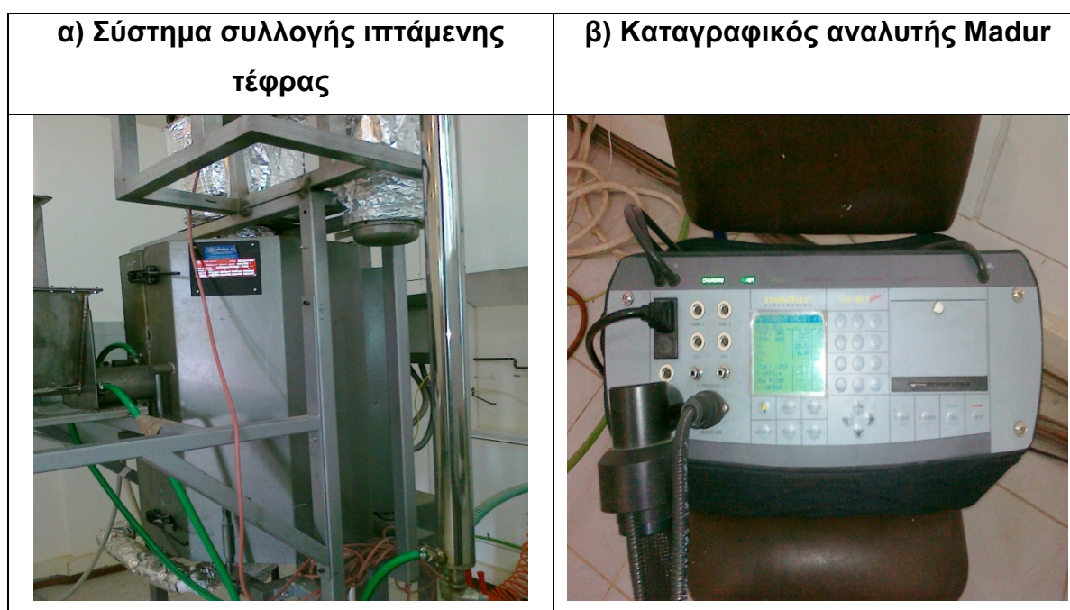
Εικόνα 3.2.3. Σύστημα συλλογής ιπτάμενης τέφρας (α), και Καταγραφικός αναλυτής Madur (β)
