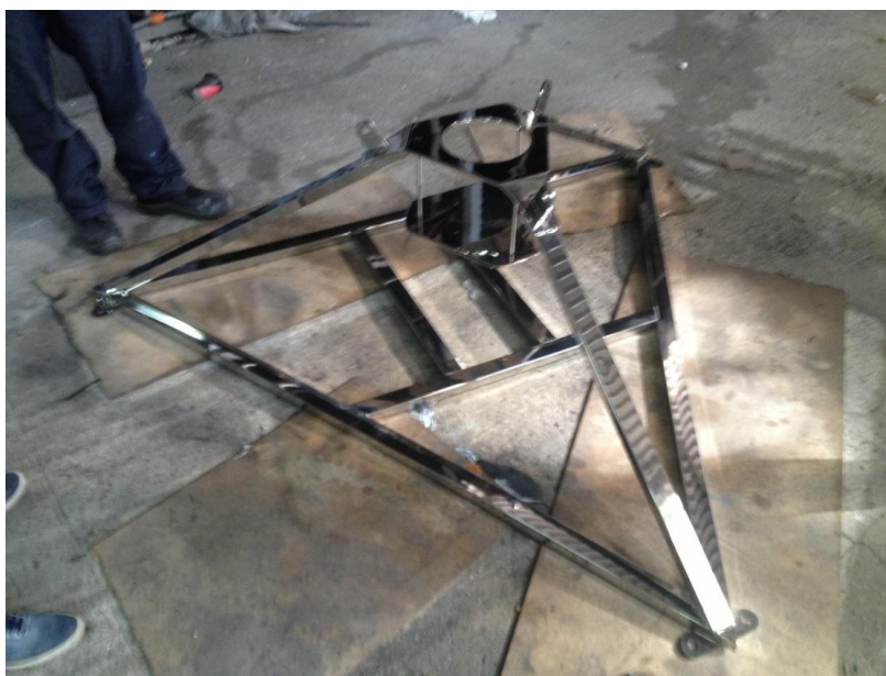
Εικόνα 3.16: Η υποθαλάσσια βάση στήριξης του awac.
