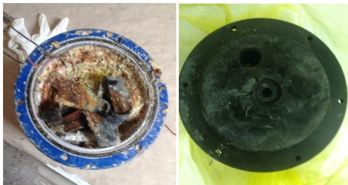
Εικόνα 3.14: Η αδιάβροχη θήκη και η μπαταρία μετά από βλάβη που εμφανίστηκε υποθαλάσσια.
