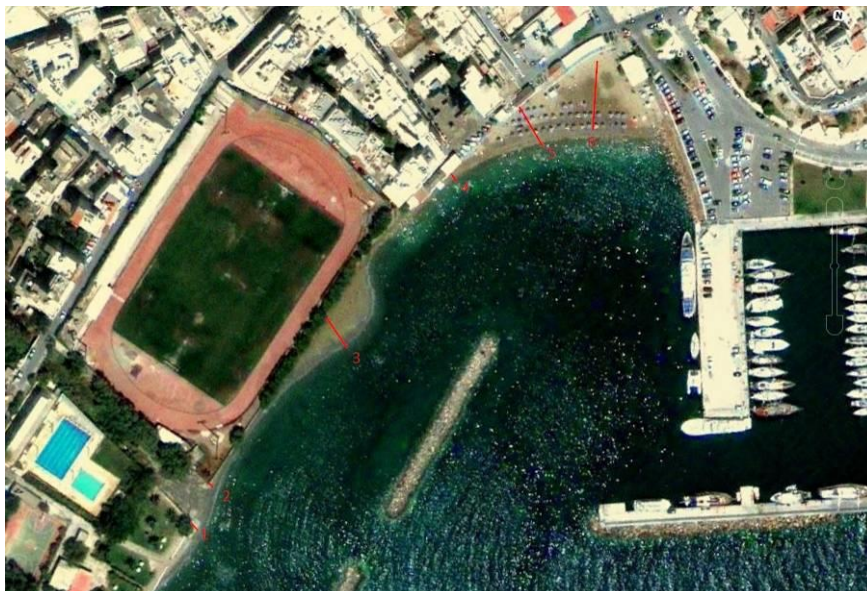
Εικόνα 6.3: Σταθερές τομές για την μέτρηση του προφίλ της παραλίας ΕΟΤ, Άγιος Νικολάος.
