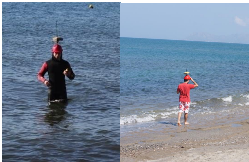
Εικόνα 3.11: Εφαρμογή της μεθόδου του κράνους RTK GPS στην παραλία της Βάρκιζας και στην παραλία του Πλατανιά, Χανιά.
