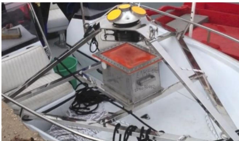
Εικόνα 3.15: Η υποθαλάσσια θήκη της μπαταρίας τοποθετημένη στην βάση στήριξης πριν από την πόντιση του.
