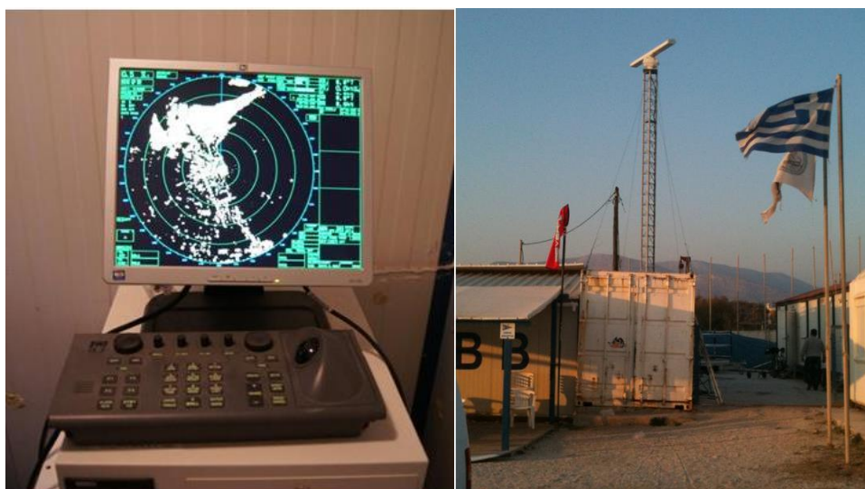
Εικόνα 7.8: Δεξιά, ο ηλεκτρονικός υπολογιστής με την ενσωματωμένη μονάδα ψηφιοποίησης βίντεο, αριστερά το συμβατικό ναυτικό X-band (3 cm) της εταιρίας Furuno σε λειτουργία τον Δεκέμβριο του 2011.
