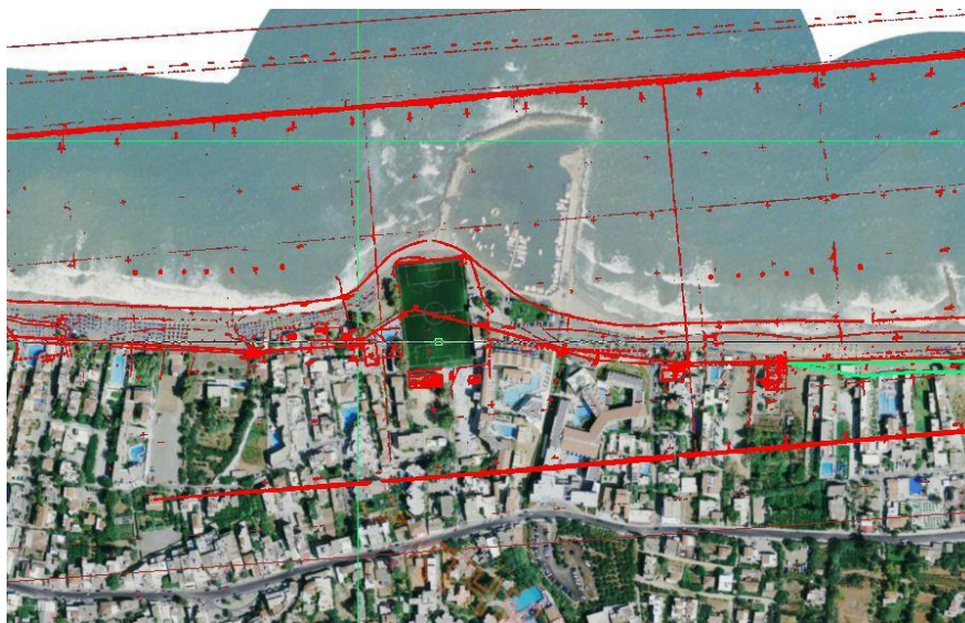
Εικόνα 8.2: Κάτοψη παραλίας Πλατανιάς, Χανιά (Google Inc., 2012) και αποτύπωση οριογραμμών παλαιού και νέου αιγιαλού (Δ/νση Τεχνικών Υπηρεσιών Χανίων, 2013). Με πράσινο χρώμα, δεξιά, εμφανίζεται η περιοχή πρόσχωσης, σύμφωνα με τους χάρτες αιγιαλού/παραλίας, στην έντονα διαβρωμένη παραλία.
