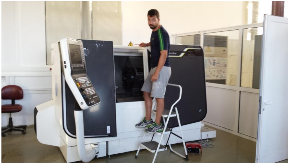
Σχήμα 3.1: Τόρνος CTX 310 ecoline
