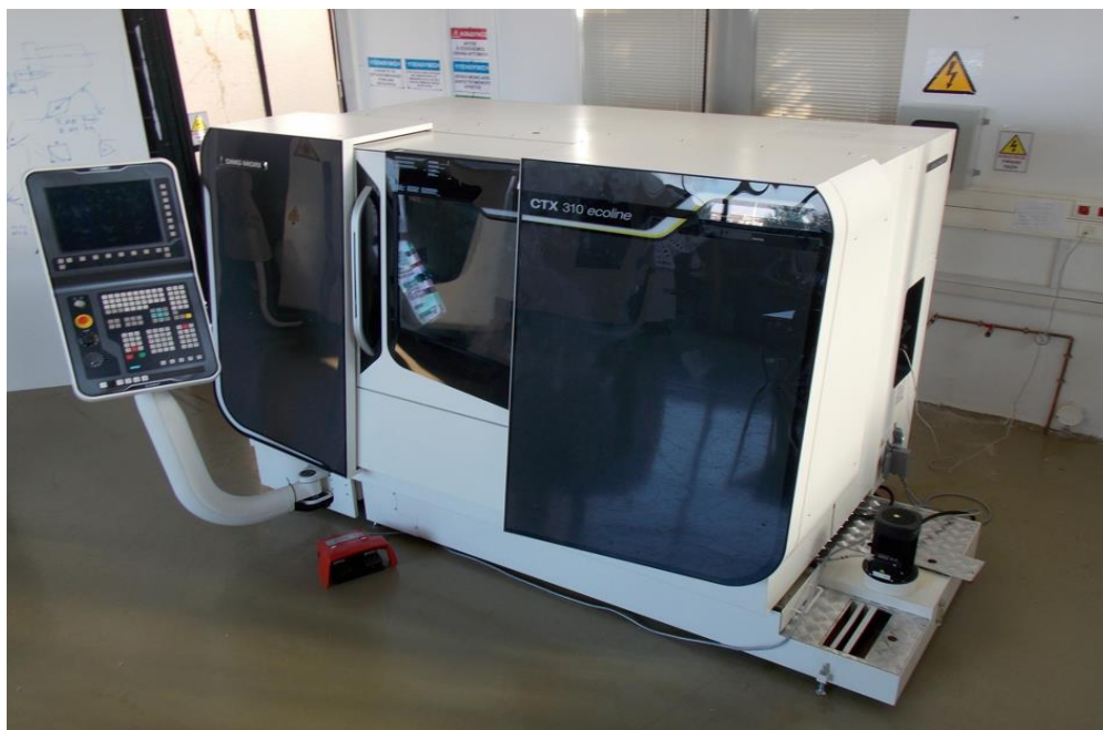
Σχήμα 3.2: Τόρνος CTX 310 ecoline
