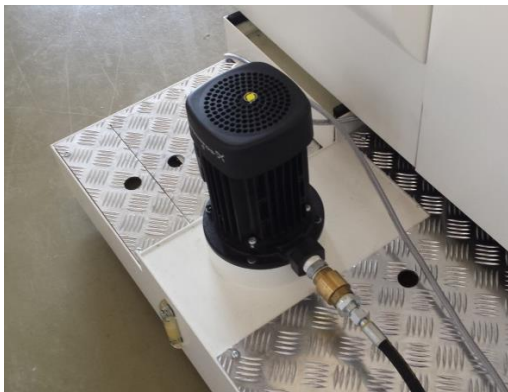
Σχήμα 3.20: Αντλία παροχής σαπουνέλαιου
