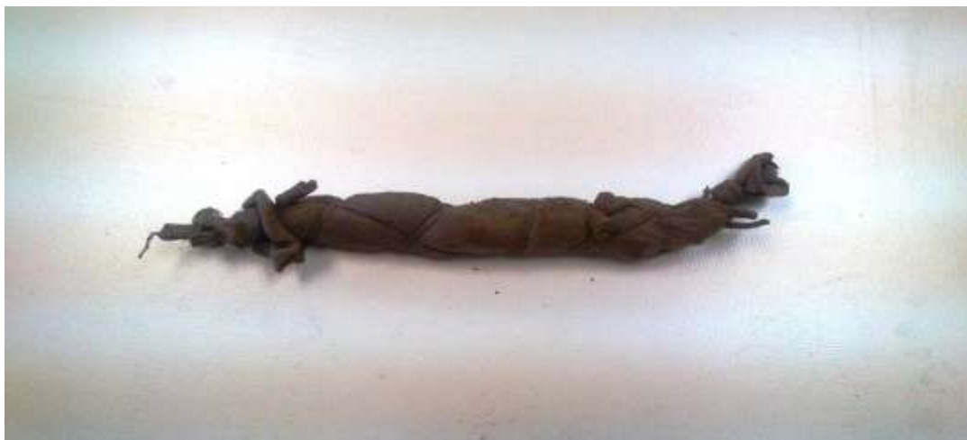
Εικόνα 11 Τοποθέτηση ζεόλιθου σε νάιλον μεμβράνη (διάμετρος ίνας 200μm)
