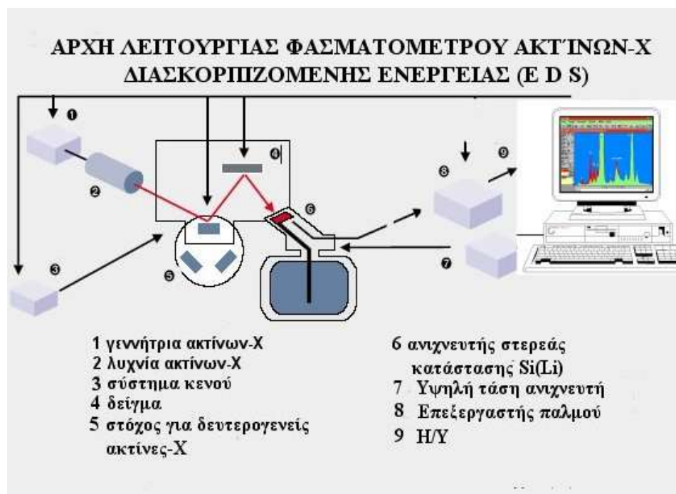
Εικόνα 7 Σχηματική απεικόνιση φασματομέτρου ακτίνων-X
