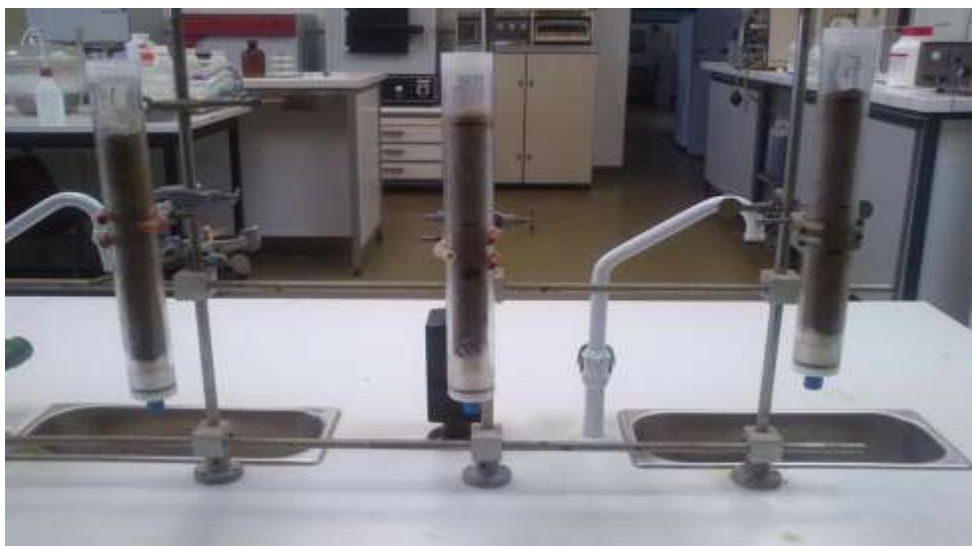
Εικόνα 12 Εργαστηριακές στήλες εκχύλισης καλίου
