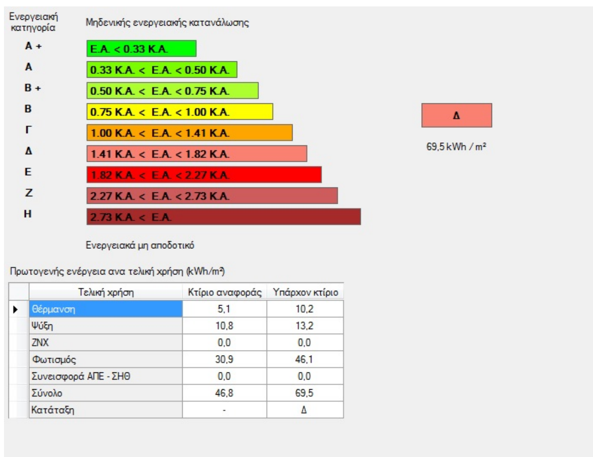
Εικόνα 28: Αποτελέσματα μετά την προσθήκη εξωτερικής μόνωσης στην οροφή.
