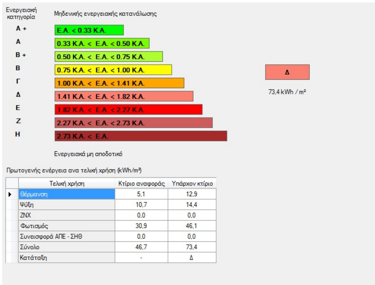
Εικόνα 29: Αποτελέσματα μετά την προσθήκη εξωτερικής μόνωσης στους εξωτερικούς τοίχους του κτιρίου
