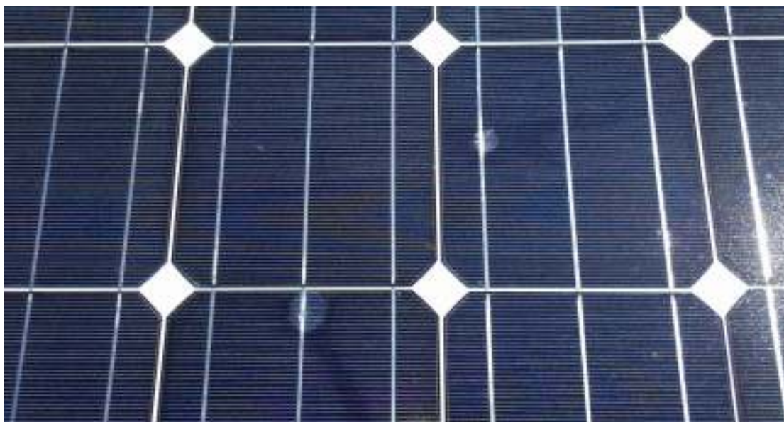
Εικόνα 3-5: Καταστροφή Φ/Β πάνελ (αποκόλληση = delamination ) εξαιτίας δημιουργίας θερμών κηλίδων
