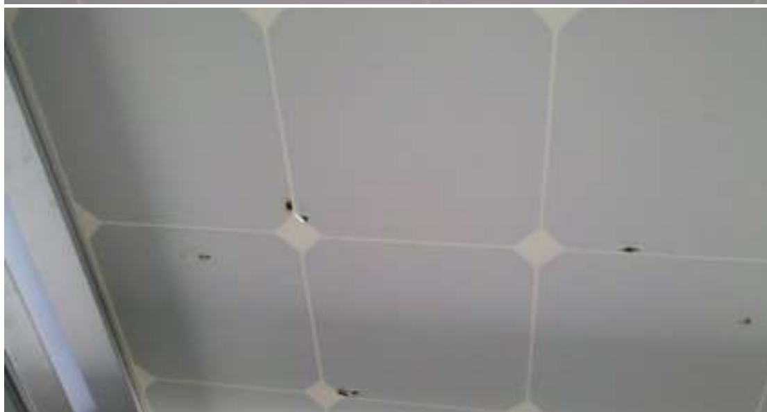
Εικόνα 3-6: Αποκόλληση-τήξη στο πίσω μέρος του ίδιου με την εικόνα 3-5 Φ/Β πάνελ
