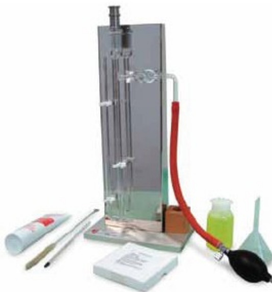
Εικόνα 2.9: Διάταξη συσκευής προσδιορισμού ειδικής επιφάνειας με τη μέθοδο διαπερατότητας με αέρα (λεπτότητα κατά Blaine).
