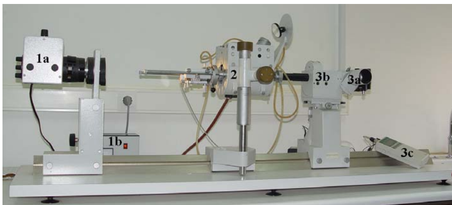
Εικόνα 2.7: Θερμαινόμενο μικροσκόπιο οριζόντιου άξονα του Εργαστηρίου Γενικής και Τεχνικής Ορυκτολογίας.
