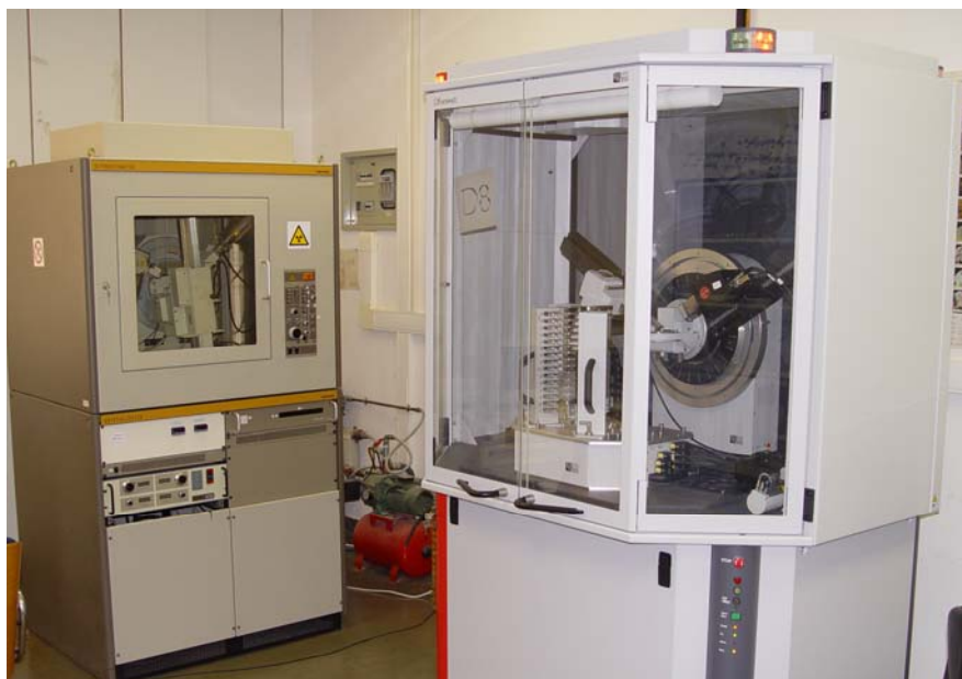
Εικόνα 2.2: Περιθλασίμετρα ακτίνων-X τύπου D5000 (αριστερά) και D8 Advance (δεξιά) του Εργαστηρίου Γενικής και Τεχνικής Ορυκτολογίας.
