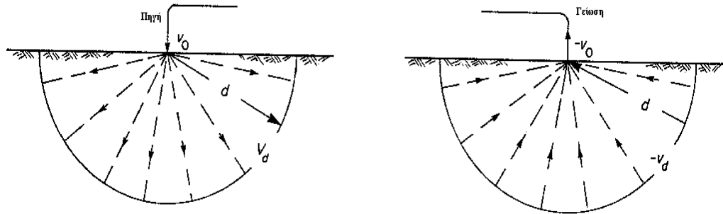
Σχήμα 3.3: Ροή ηλεκτρικού ρεύματος σε ομοιογενή και ισότροπη γη στην περίπτωση που δεν υπάρχει αλληλεπίδραση μεταξύ των δύο ηλεκτροδίων (Γκανιάτσος, 2000, Σούρλας, 2000).
