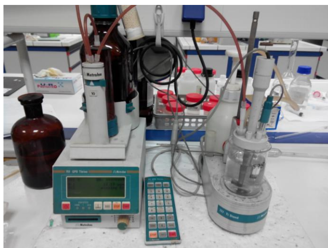
Εικόνα 0-11 Τιτλοδότης προσδιορισμού συγκέντρωσης χλωριόντων της εταιρείας Metrohm
