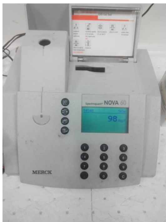
Εικόνα 0-12 Φωτόμετρο της εταιρείας Merck για τον προσδιορισμό του περιεχόμενου θείου
