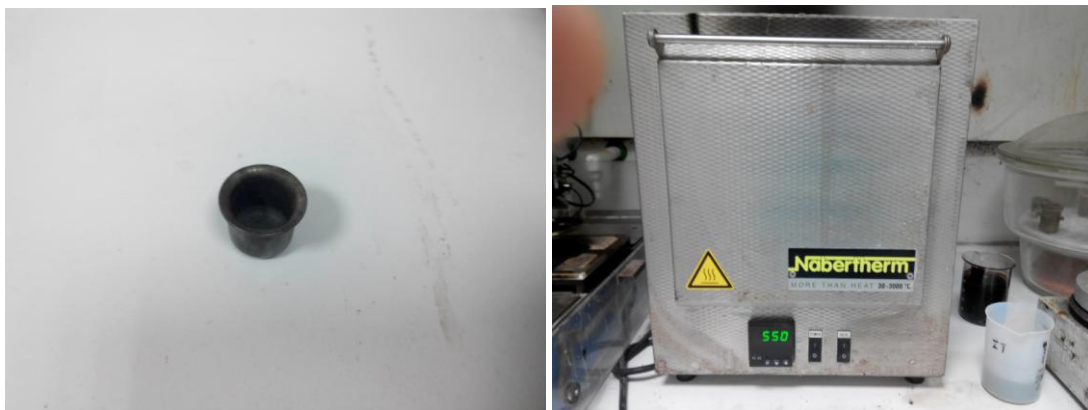
Εικόνα 0-4 Κάψα με στερεό εναλλακτικό καύσιμο για τον προσδιορισμό της τέφρας Εικόνα 0-5 Φούρνος υψηλών θερμοκρασιών του οίκου Nabertherm
