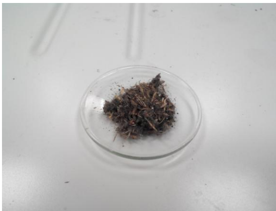
Εικόνα 0-2 Ύαλος ωρολογίου με στερεό εναλλακτικό καύσιμο για τον προσδιορισμό του στερεού υπολείμματος
