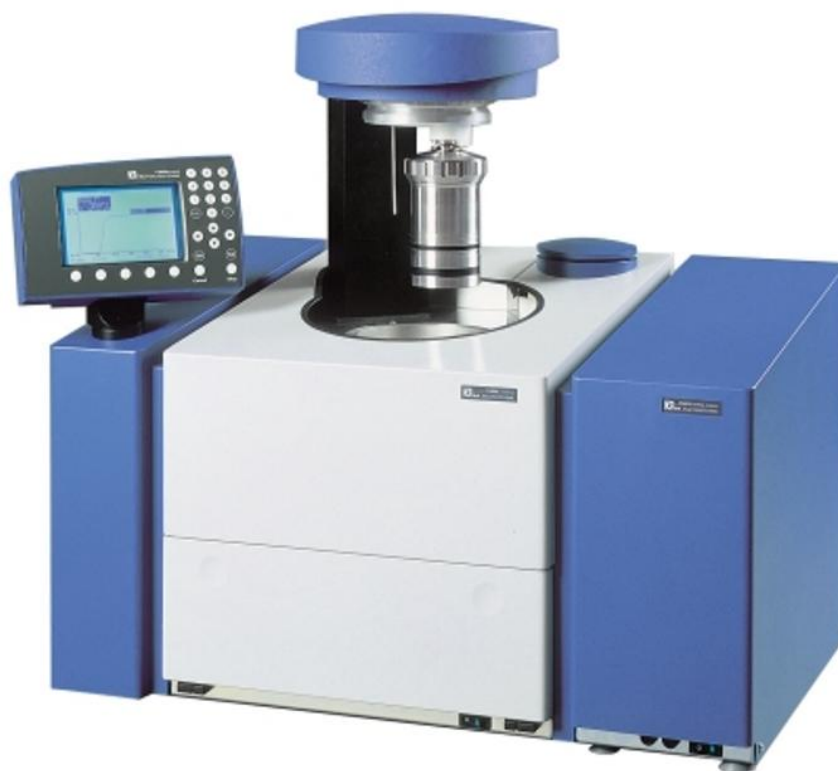
Εικόνα 0-9 Θερμιδόμετρο της εταιρείας IKA
