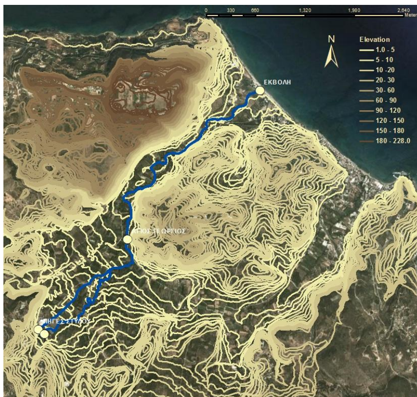
Εικόνα 4.11. Ψηφιοποίηση τοπογραφίας από τοπογραφικούς χάρτες Γεωγραφικής Υπηρεσίας Στρατού για την περιοχή μελέτης (κλίμακα ανάλυσης 1: 5000)
