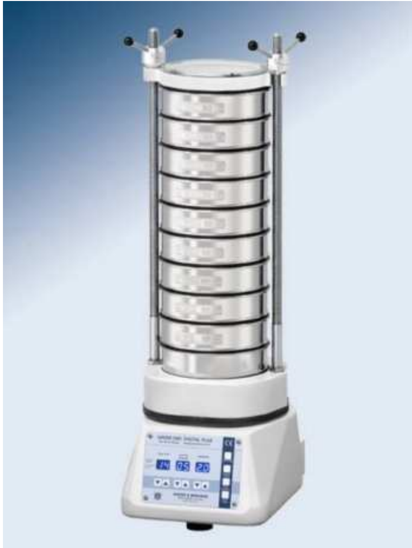
Εικόνα 6.5:κοσκίνα και συσκευή δονησεως[35].
