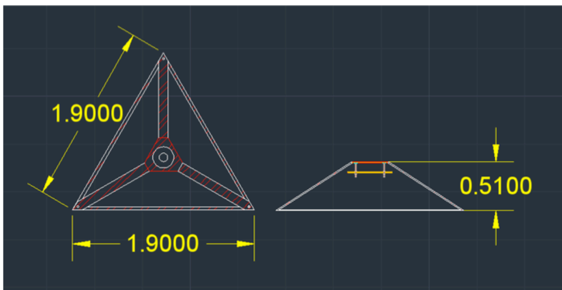
Εικόνα 5-10: Σχεδιασμός βάσης τοποθέτησης Awac στο AutoCad
