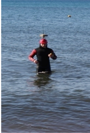
Εικόνα 5-6:Χρήστης κατά την διάρκεια λήψης μετρήσεων.Το Rover στήριζεται με κράνος και είναι σταθερά στο κεφάλι του χρήστη, και στο χέρι το PDA.
