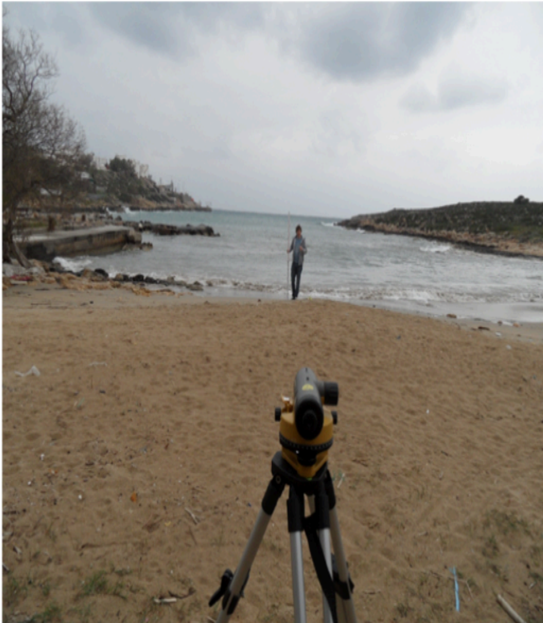
Εικόνα 5-2: Χωροβάτης και στην απέναντι πλευρά ο χρήστης με το κοντάρι
