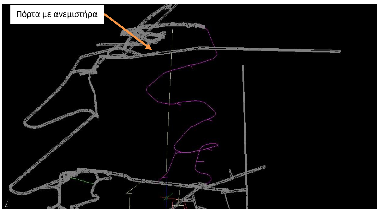
Εικόνα 5.7 Τροφοδοσία αέρα στο “τυφλό μέτωπο” της άνω ανατολικής ράμπας.
