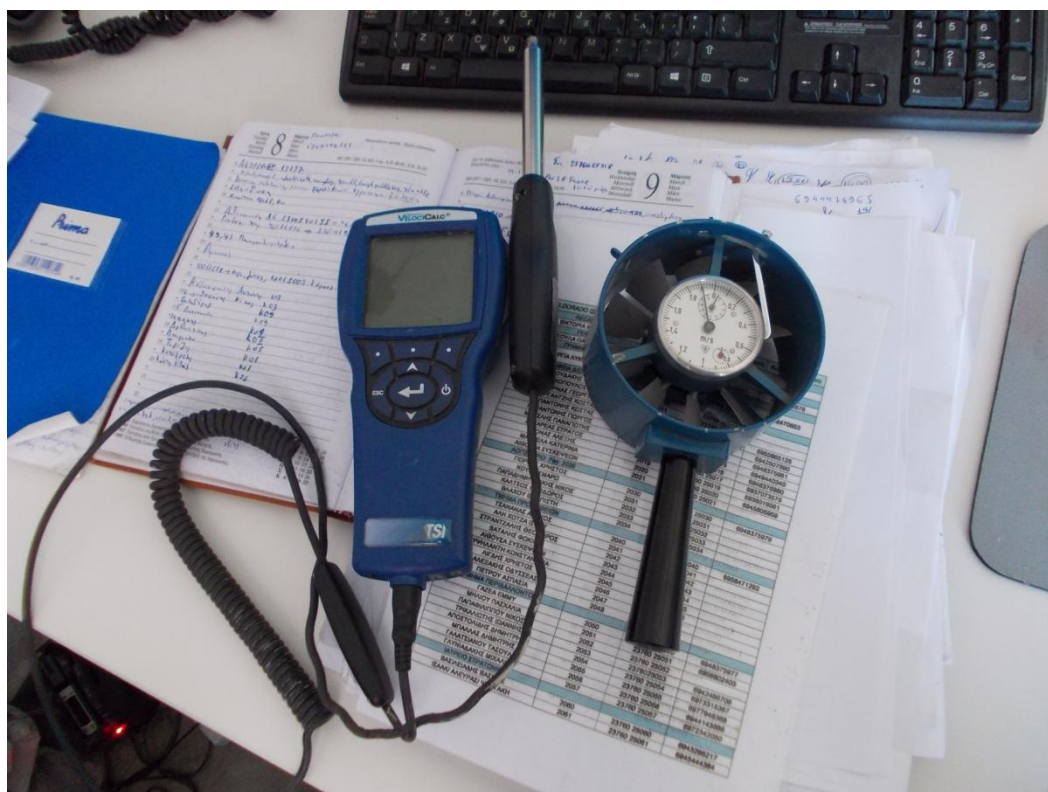
Εικόνα 5.13 Θερμικό ανεμόμετρο (αριστερά) και ανεμόμετρο με μιλίσκο (δεξιά).
