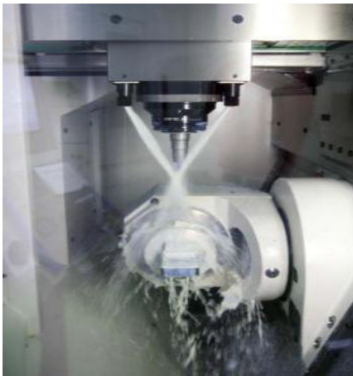
Εικόνα 1.1.3 Κατεργασία φρεζαρίσματος υψηλών ταχυτήτων HSM
