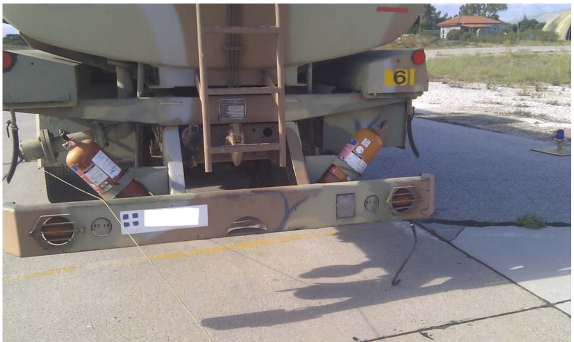
Εικόνα 5: Οπίσθιος προφυλακτήρας βαρέως τύπου
