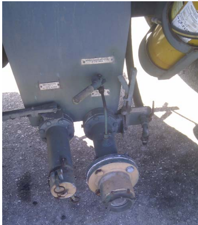
Εικόνα 4: Ταχυσύνδεσμοι 2,5in πολιτικού και στρατιωτικού τύπου
