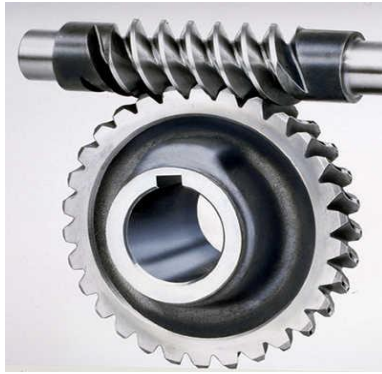
Σχήμα 2.7 : Εμπλοκή- Συνεργασία οδοντωτού τροχού με κοχλία.
