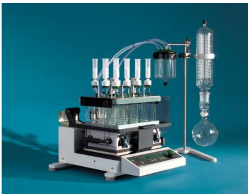
Εικόνα 2.2: Συσκευή πραγματοποίησης της μεθόδου SPE
