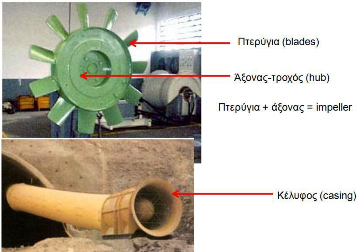
Εικ.8.1 Βασικά κομμάτια κυκλώματος αερισμού
