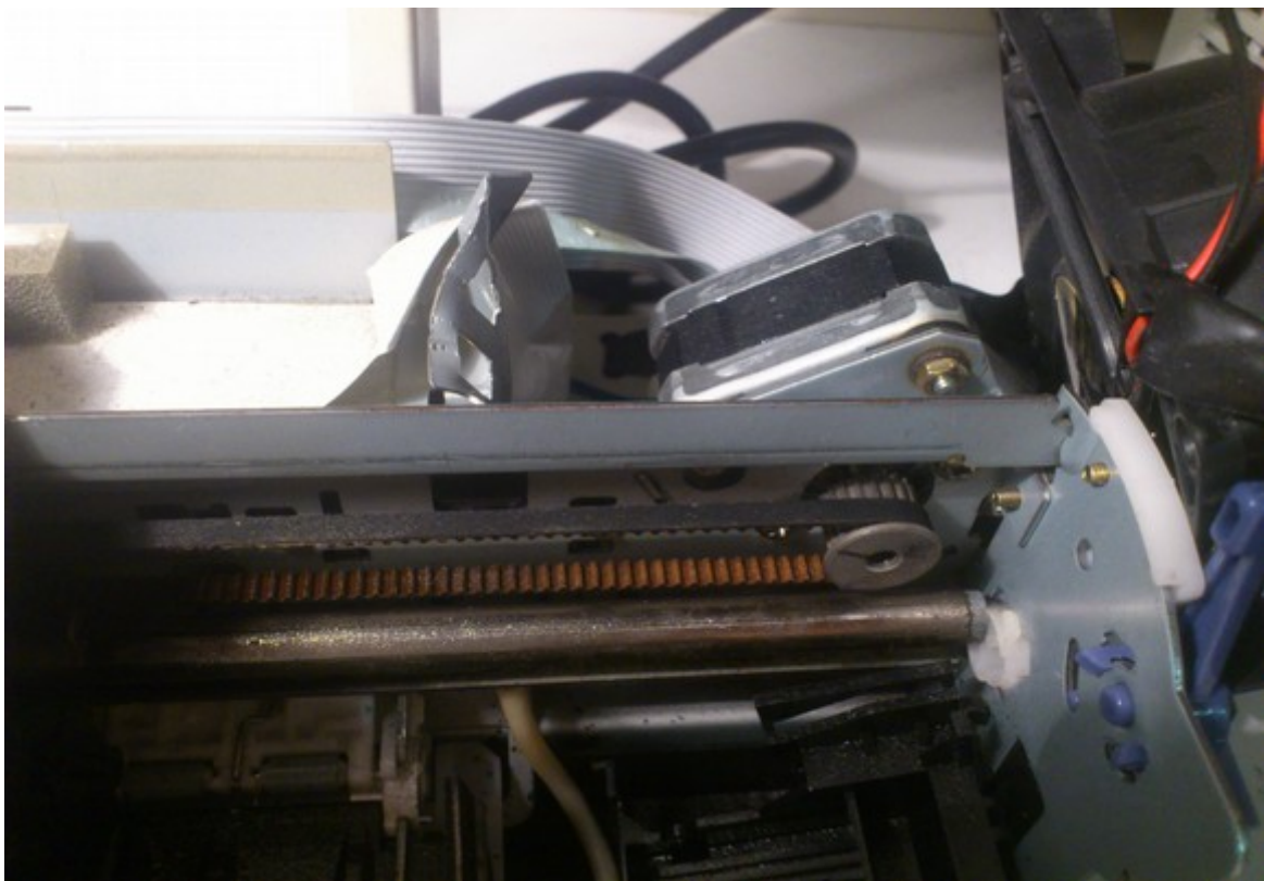
Σχήμα 2.16. Το stepper motor της κατασκευής.
