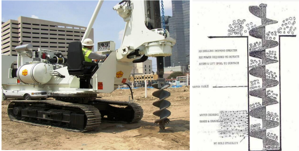
Εικόνα 2.3 : Γεωτρύπανο ελικοειδούς διάτρησης (Solid stem auger drilling), πηγή: www.augerdrilling.com , Κελεσίδης, 2012.
