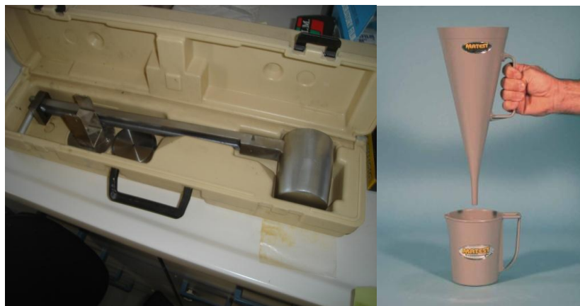
Εικόνα 4.3: Ζυγός μέτρησης πυκνότητας πολφού του εργαστηρίου Τεχνικής Γεωτρήσεων και Ρευστομηχανικής στο Πολυτεχνείο Κρήτης (αριστερά). Χωνί Marsh (δεξιά), πηγή: προσωπικό αρχείο, www.matest.com .
