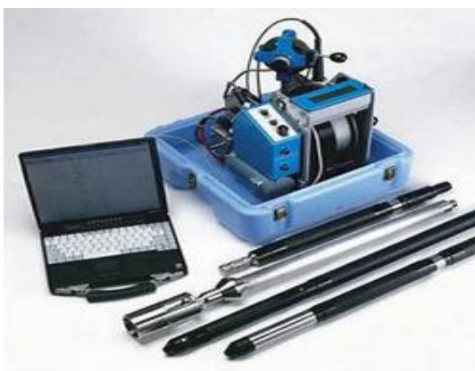
Εικόνα 5.2 : Εξοπλισμός διαγραφής ηλεκτρικής αντίστασης (πηγή: Σουπιός, 2011).
