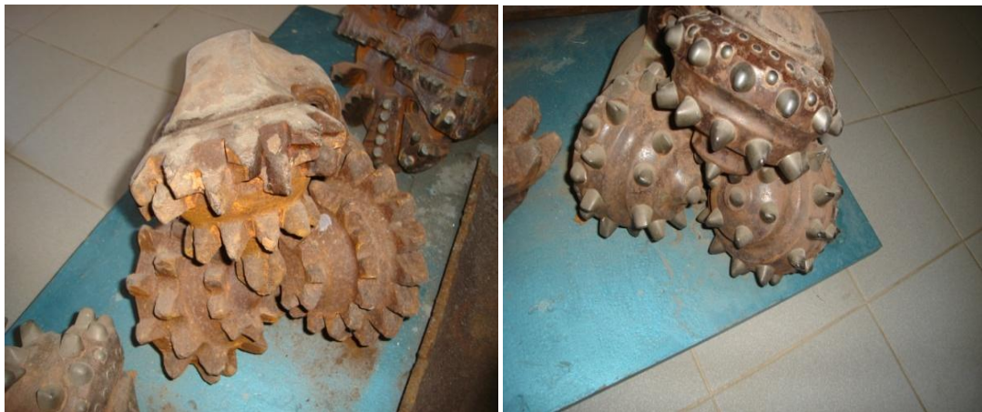
Εικόνα 3.4 : Τρίκωνο περιστροφικό κοπτικό άκρο με ένθετα βολφραμίου (δεξιά) και χαλύβδινα δόντια (αριστερά) του εργαστηρίου Τεχνικής Γεωτρήσεων στο Πολυτεχνείο Κρήτης.
