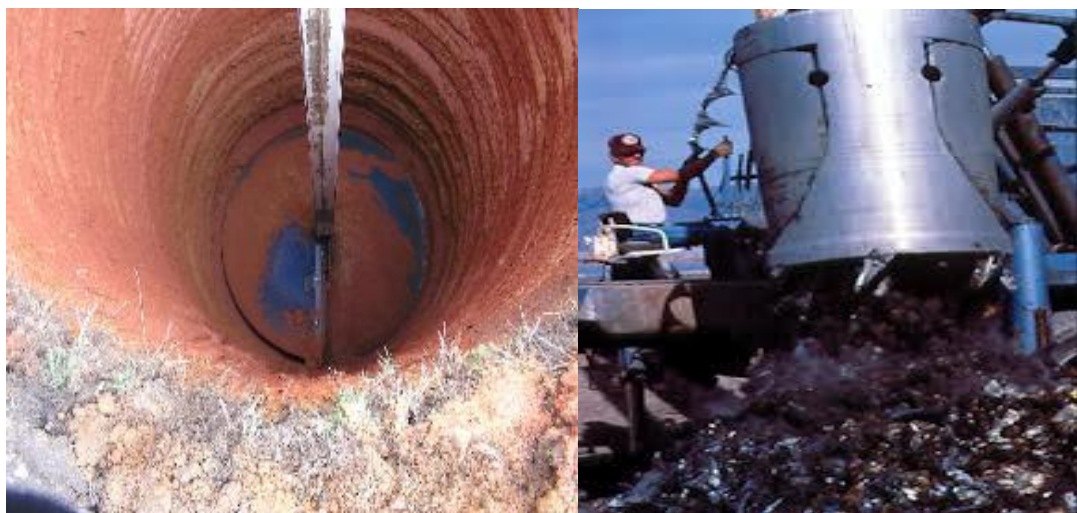
Εικόνα 2.4: Διάτρηση με την περιστροφική μέθοδο με κάδο (πηγή: thompsonbrothersdrilling.com , www.foxloomisinc.com ).
