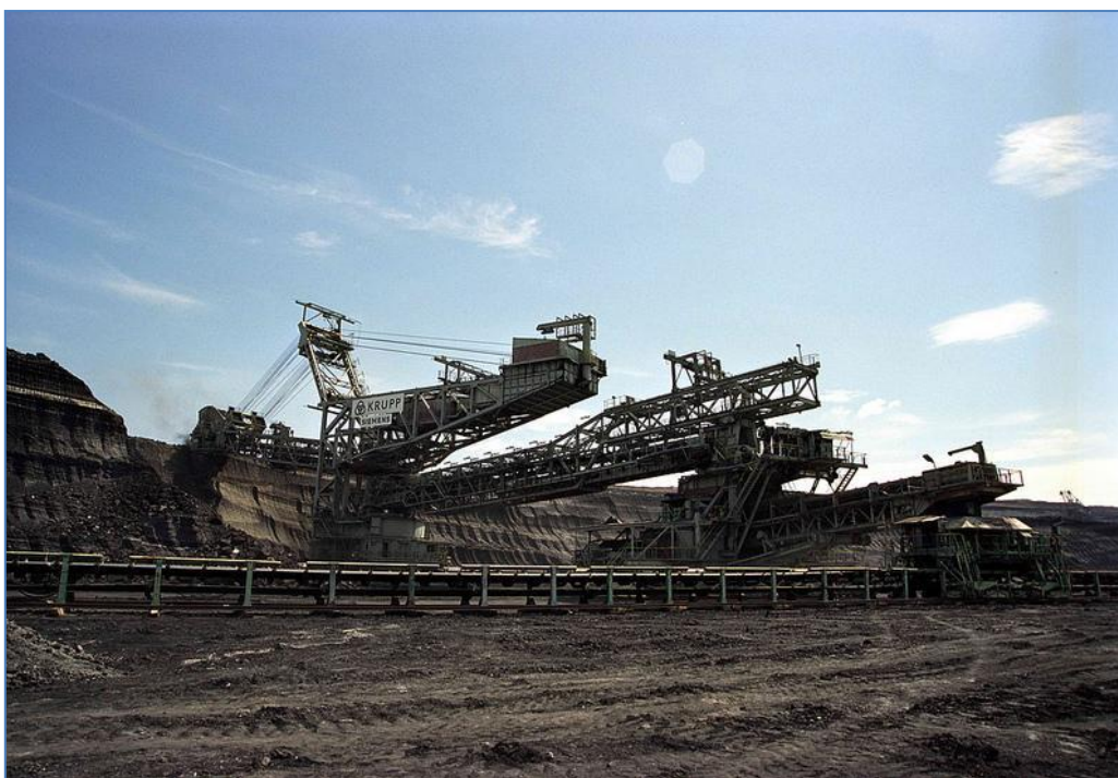
Σχήμα 1.4: Εκμετάλλευση λιγνιτωρυχείου με τη μέθοδο συνεχούς λειτουργίας ή Γερμανική μέθοδος.
