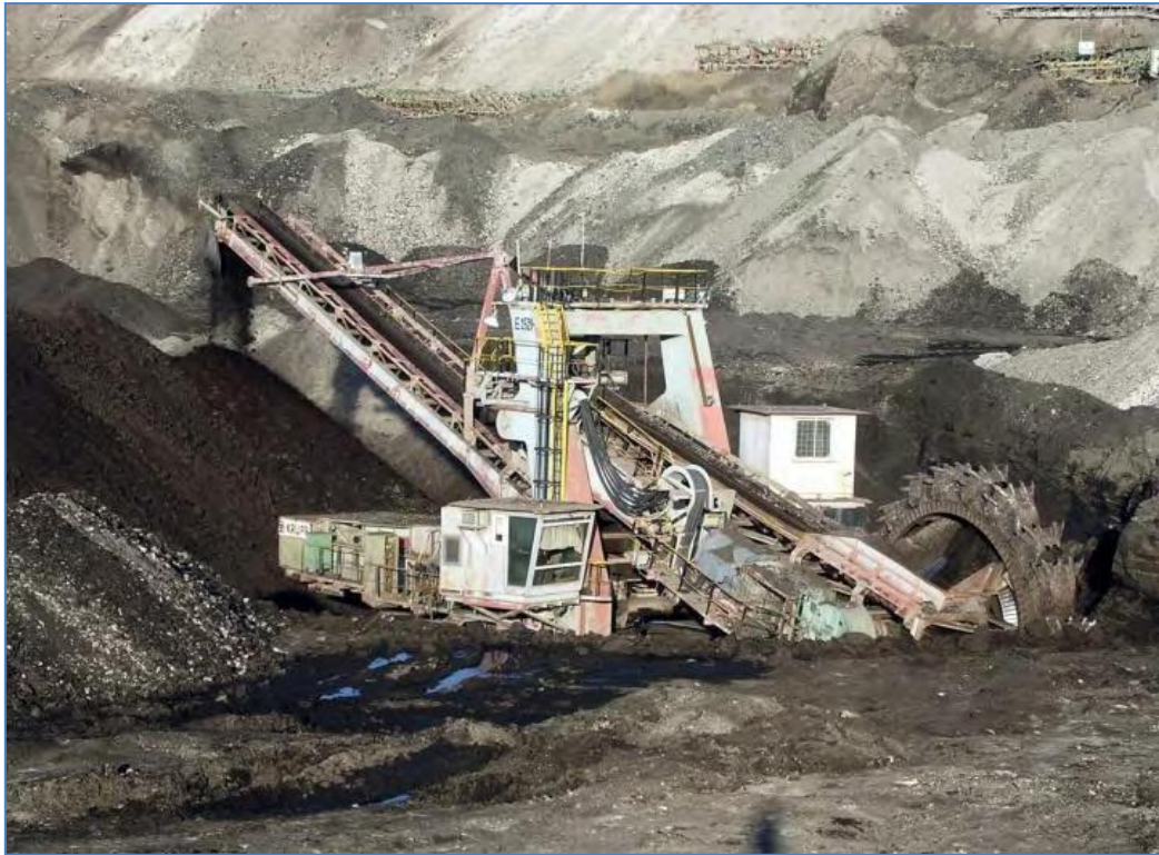
Σχήμα 2.15: Καδοφόρος εκσκαφέας τύπου compact εξορύσσει λιγνίτη και τον αποθέτει σε σωρούς, από τους οποίους πρέπει στη συνέχεια να φορτωθεί σε φορτηγά με τη βοήθεια φορτωτή (Ρούμπος, 2010).
