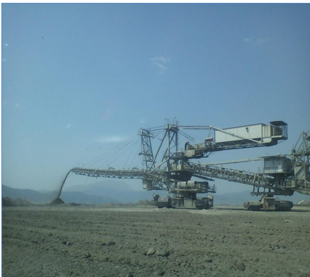
Σχήμα 2.7: Ο αποθέτης Α1 του ορυχείου αποθέτει τα άγονα στο παλιό ορυχείο Κυρίου Πεδίου.
