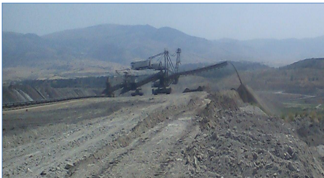
Σχήμα 2.12: Εργασία αποθέτη σε «χαμηλή» απόθεση.
