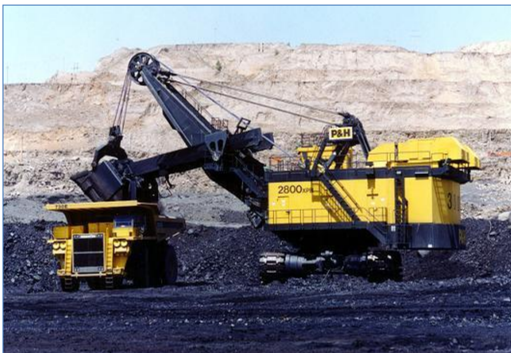
Σχήμα 1.5: Εκμετάλλευση με τη μέθοδο ασυνεχούς εξόρυξης ή Αμερικάνικη μέθοδος.
