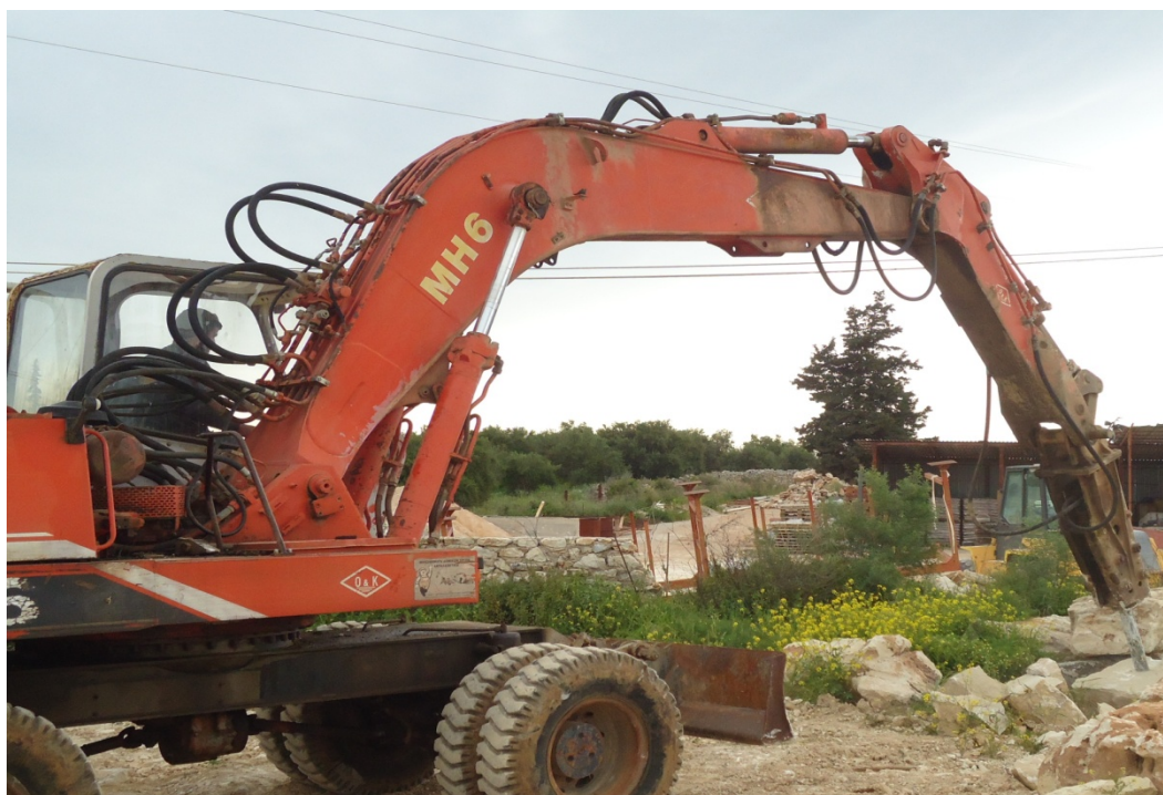
Σχήμα 4.7 : Ελαστιχοφόρος εκσκαφέας εξοπλισμένος με υδραυλική σφύρα.
