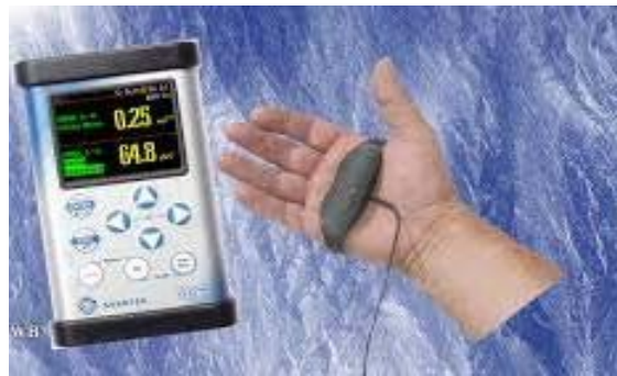
Σχήμα 3.5 : Πιεζοηλεκτρικός αισθητήρας για μέτρηση κραδασμών στο σύστημα χειρός-βραχίονα συνδεδεμένος με τη μονάδα καταγραφής και επεξεργασίας ( www.svante.com ).
