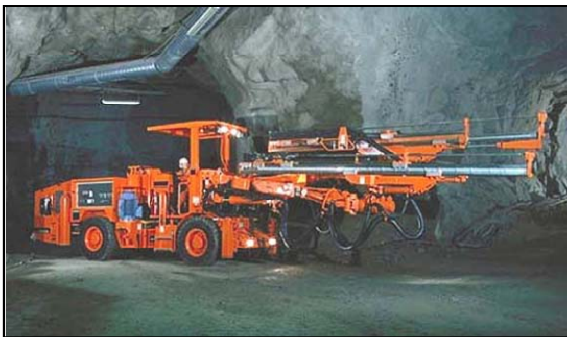
Σχήμα 1.4: Διατρητικό φορείο (jumbo drill) με δύο διατρητικούς βραχίονες (μπούμες) που χρησιμοποιείται για την διάνοιξη διατρημάτων σε υπόγεια μεταλλευτικά και τεχνικά έργα ( www.metal.ntua.gr ).
