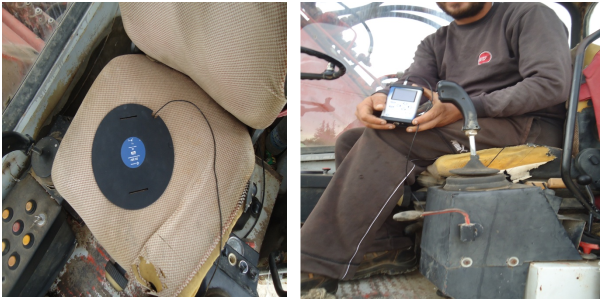
Σχήμα 4.6 : Όργανο καταγραφής και επεξεργασίας Svan106 και τον αισθητήρα SV 38V.
