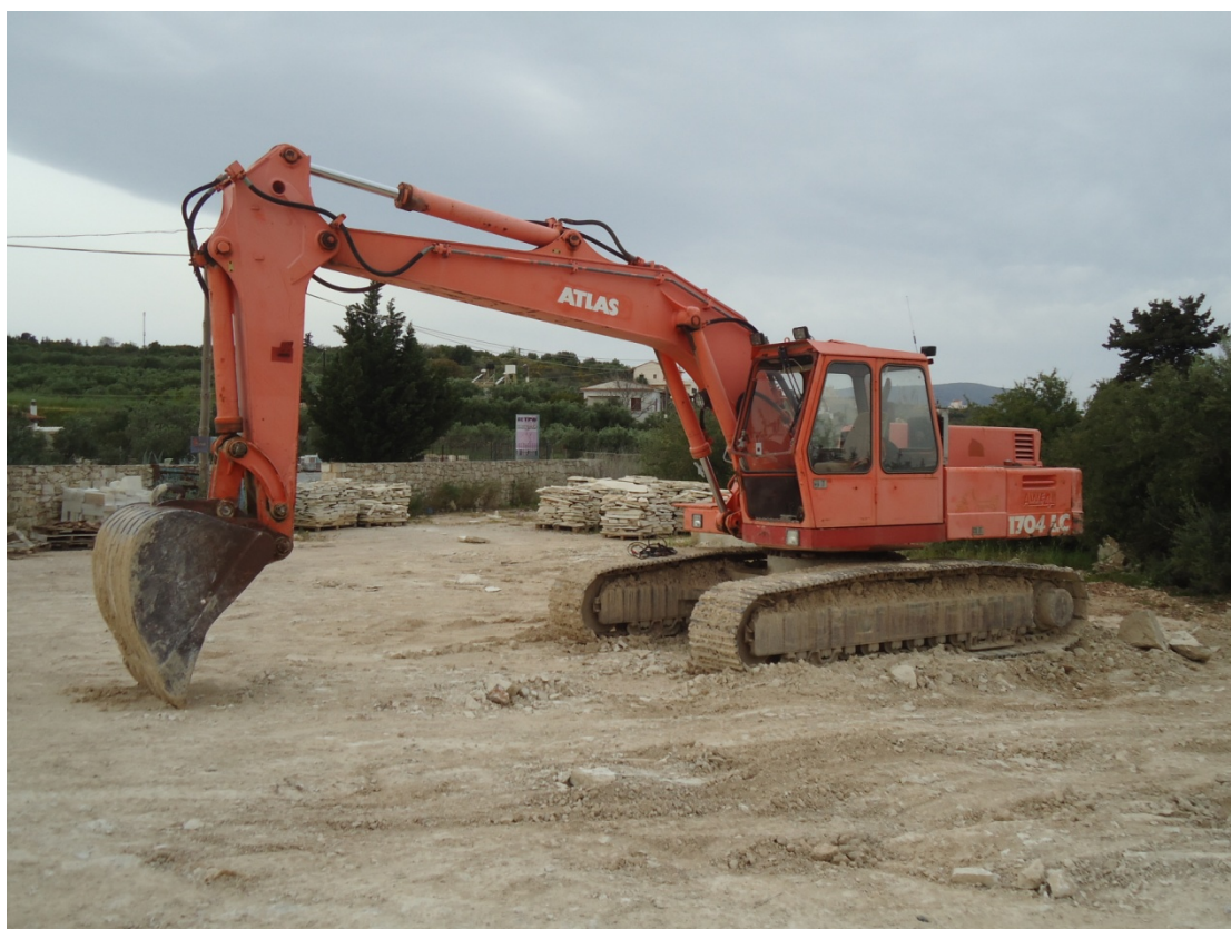
Σχήμα 4.8 : Ερπυστριοφόρος εκσκαφέας με ανεστραμμένο κάδο (τσάπα).
