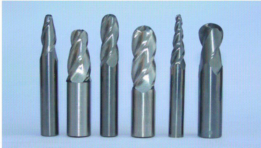
Σχήμα 2.2 : Κοπτικά εργαλεία σφαιρικής απόληξης
