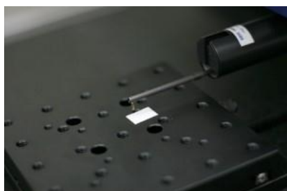
Σχήμα 2.5 : Τραχύμετρο στυλίσκου
