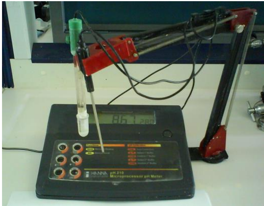
Σχήμα 6.12: Συσκευή μέτρησης pH και θερμοκρασίας, pH 210 της HANNA instruments, του εργαστηρίου Τεχνικής Γεωτρήσεων και Ρευστομηχανικής.
