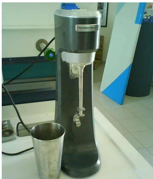
Σχήμα 7.2: Αναδευτήρας της Hamilton Beach, δυνατότητας ανάδευσης 11000 rpm.
