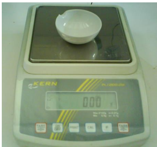
Σχήμα 7.3: Ζυγός ακριβείας 0.01 g για την παρασκευή των δειγμάτων.
