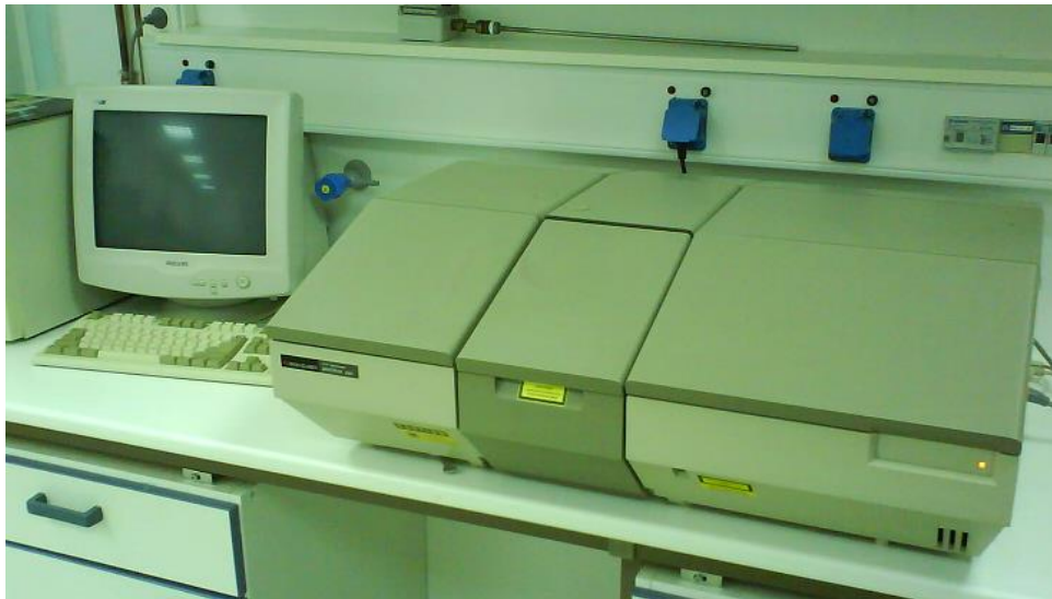
Σχήμα 6.8: Πειραματική διάταξη F.T.I.R. της Perkin – Elmer του εργαστηρίου Ανάλυσης Ρευστών και Πυρήνων Υπόγειων Ταμιευτήρων.
