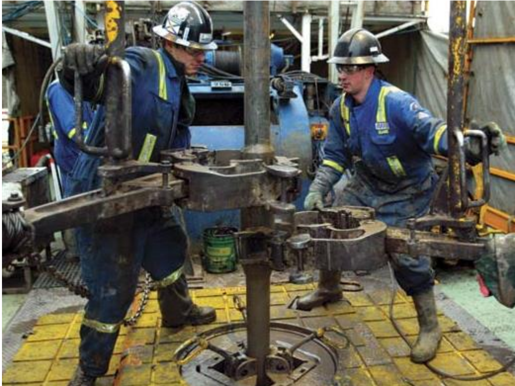
Σχήμα 3.3: Εργασία πρόσθεσης στελεχών διατρητικής στήλης κατά την γεώτρηση πετρελαίου. (web 5)
