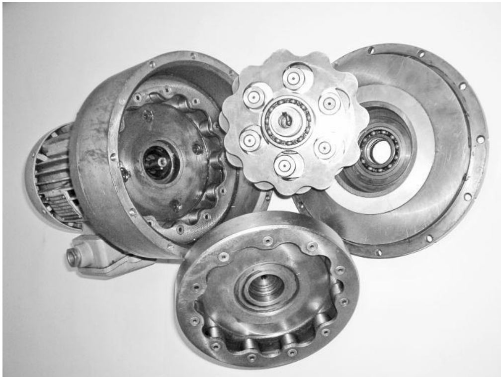
Σχήμα 2.5.1. Παράδειγμα κυκλοειδή μειωτήρα
