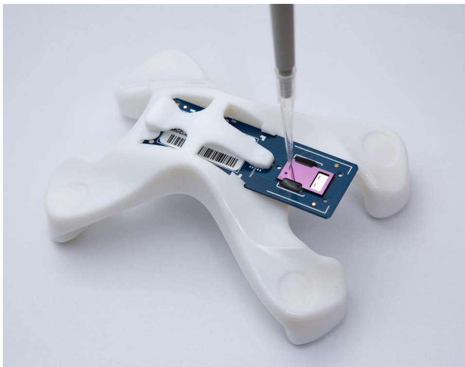
Εικόνα 2: το VereFlu TM Lab-on-Chip της εταιρίας Veredus Laboratories ανιχνεύει τη γρίπη των πτηνών H7N9 με εξαιρετικά μικρή ποσότητα όγκου υγρού δείγματος [227].
