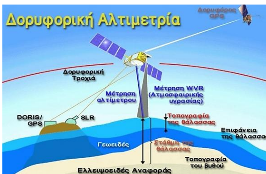
Εικόνα 2.2: Αρχή λειτουργίας της δορυφορικής αλτιμετρίας (NTUA, 2014)
