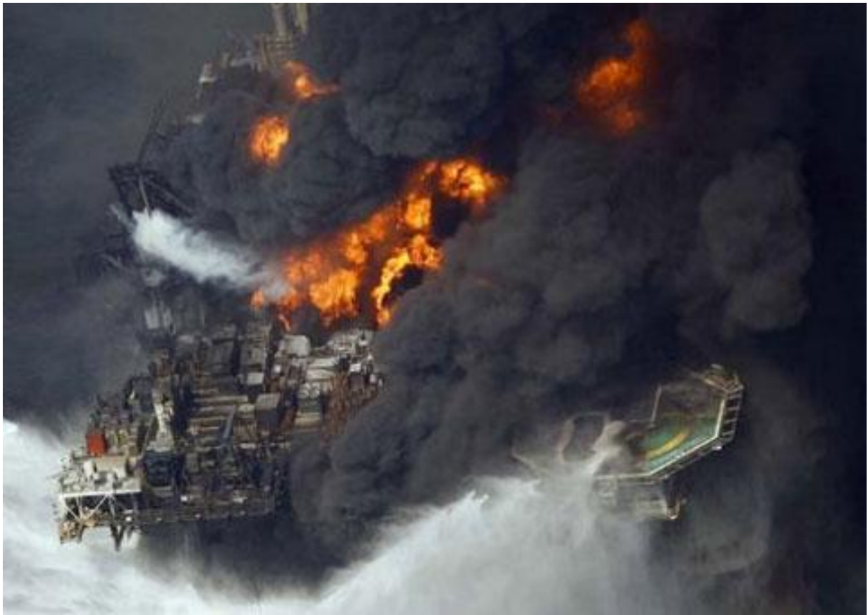
Εικόνα 2.7 (α): Η έκρηξη στη πλατφόρμα πετρελαίου Deepwater Horizon η οποία προκλήθηκε από μη ελεγχόμενο "kick" (WSWS, 2014)
