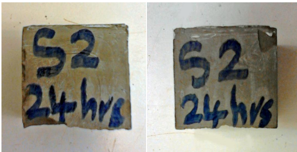
Εικόνα 8.1.3 (στ): Κυβικό δοκίμιο τσιμέντου του Sample 2-24 ώρες από την έναρξη της ενυδάτωσης
