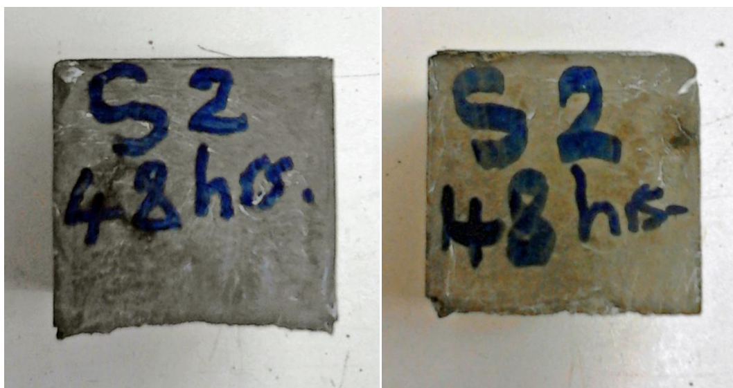
Εικόνα 8.1.3 (ζ): Κυβικό δοκίμιο τσιμέντου του Sample 2-48 ώρες από την έναρξη της ενυδάτωσης
