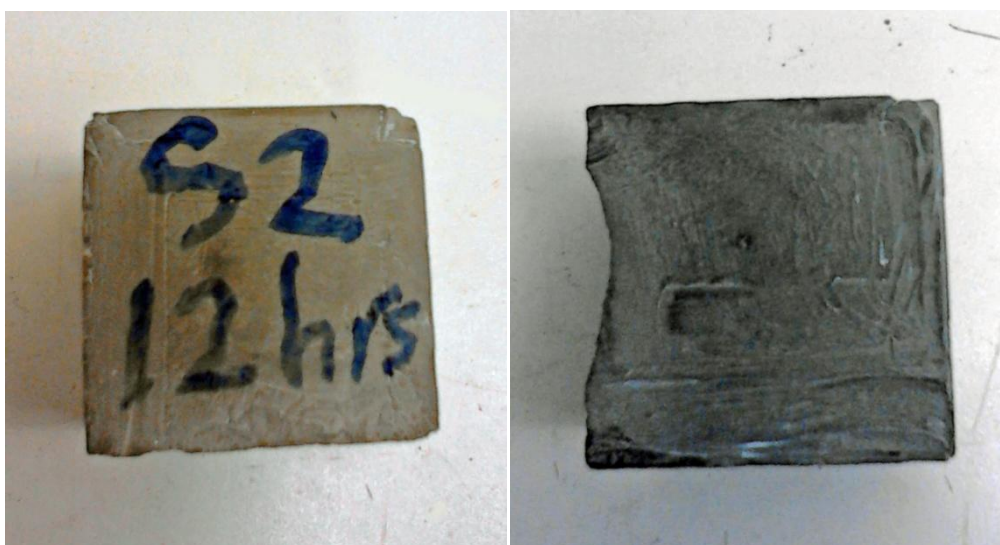
Εικόνα 8.1.3 (ε): Κυβικό δοκίμιο τσιμέντου του Sample 2-12 ώρες από την έναρξη της ενυδάτωσης
