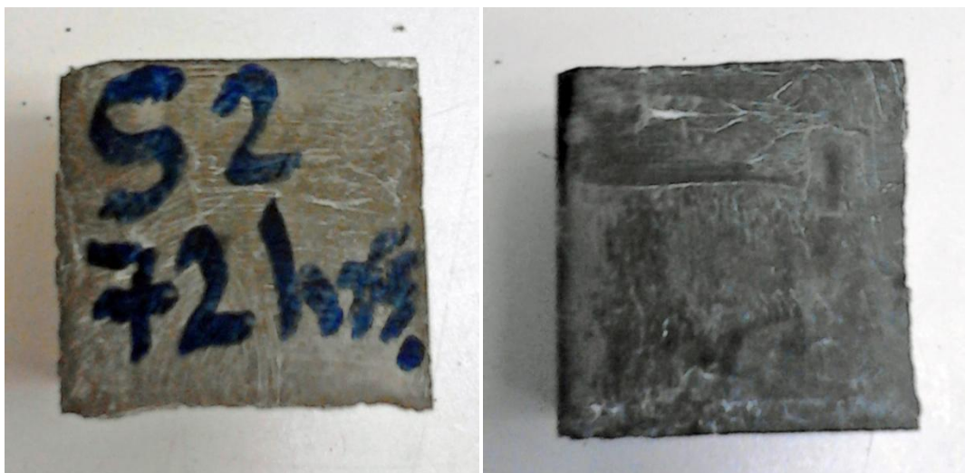
Εικόνα 8.1.3 (η): Κυβικό δοκίμιο τσιμέντου του Sample 2-72 ώρες από την έναρξη της ενυδάτωσης
