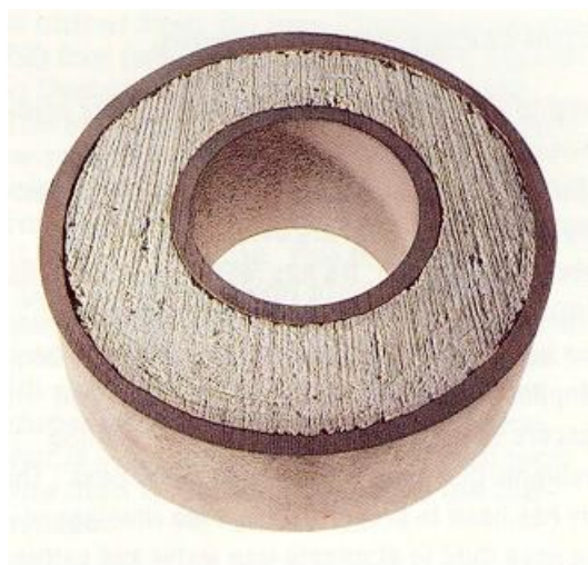
Εικόνα 2.10 (δ): Τσιμεντώση σωλήνων - Δείγμα εργαστηρίου (Κελεσίδης, 2009)
