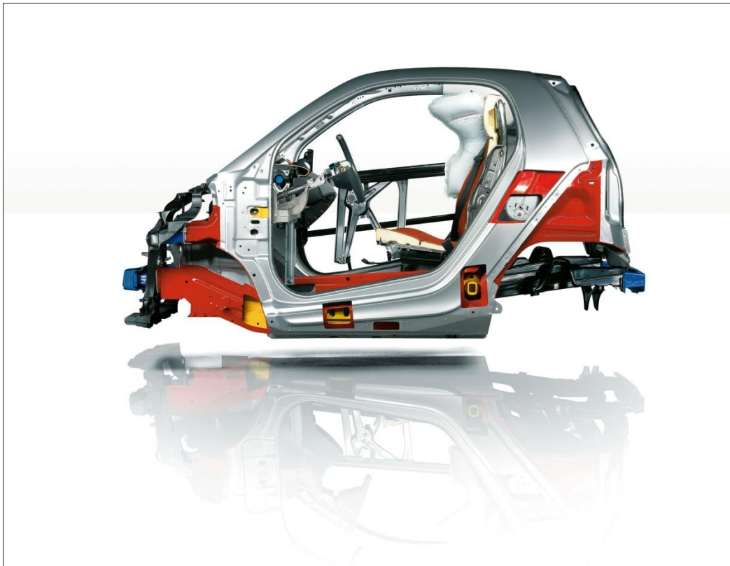
Εικόνα 2.30: Πλάγια όψη του κλωβού ασφαλείας του Smart Fortwo
