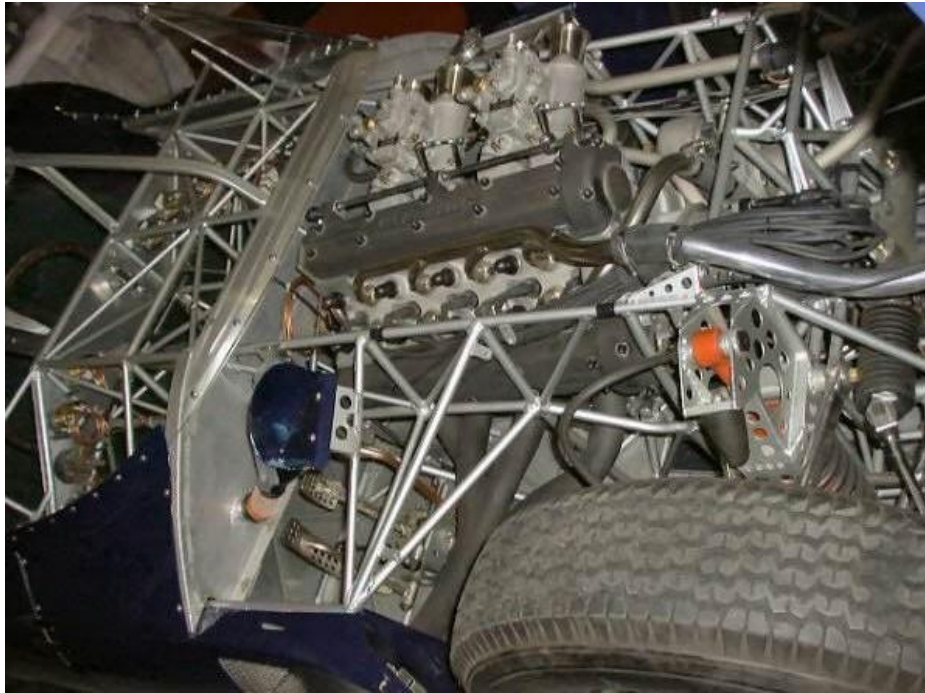
Εικόνα 2.5: Πλαίσιο Birdcage σε αυτοκίνητο της Maserati
