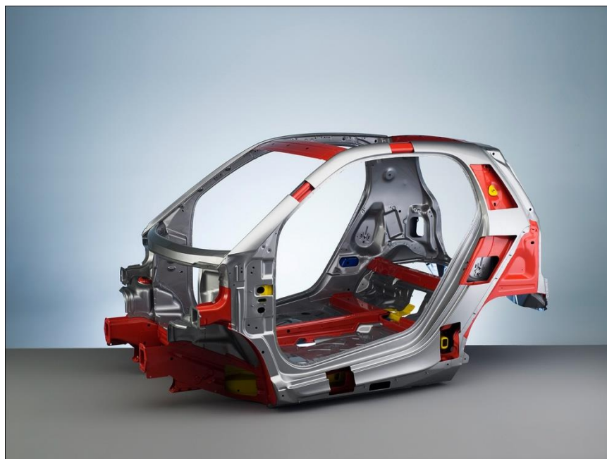
Εικόνα 2.29: Εμπρόσθια-πλαινή όψη του κλωβού ασφαλείας του Smart Fortwo
