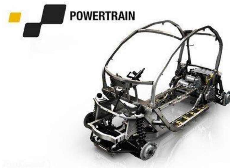
Εικόνα 2.25: Το πλαίσιο του Renault Twizy
