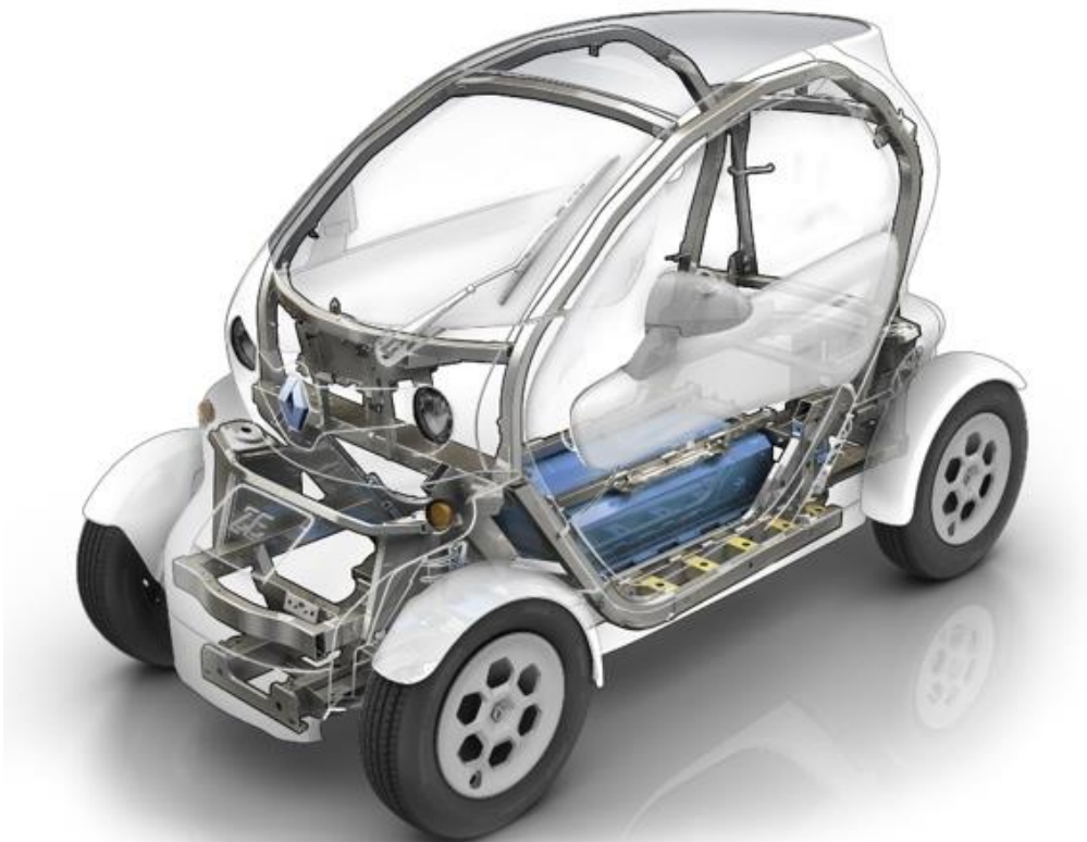
Εικόνα 2.27: Οι μηχανισμοί παθητικής ασφάλειας του Renault Twizy
