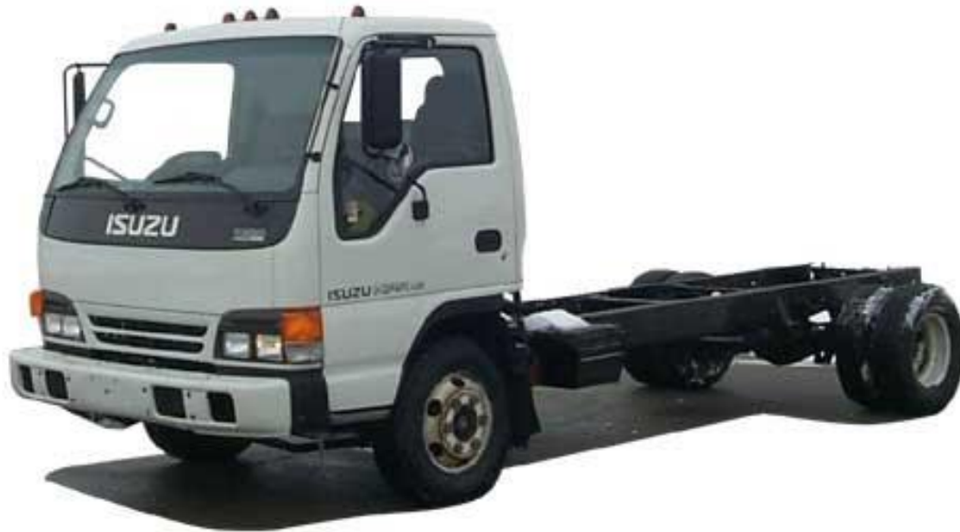
Εικόνα 2.3: Πλαίσιο-Σκάλα της εταιρίας Isuzu
