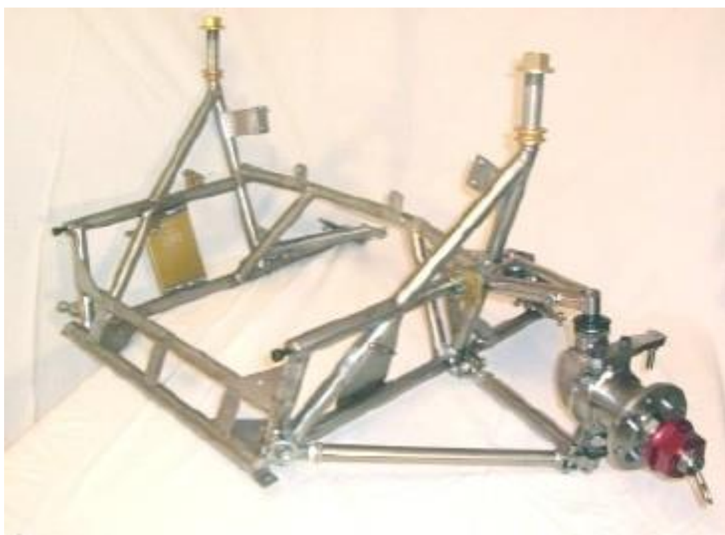
Εικόνα 2.13: Εμπρόσθιο υποπλαίσιο
