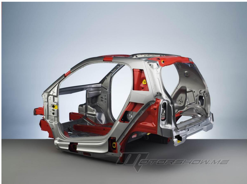
Εικόνα 2.28: Οπίσθια-πλαινή όψη του κλωβού ασφαλείας του Smart Fortwo
