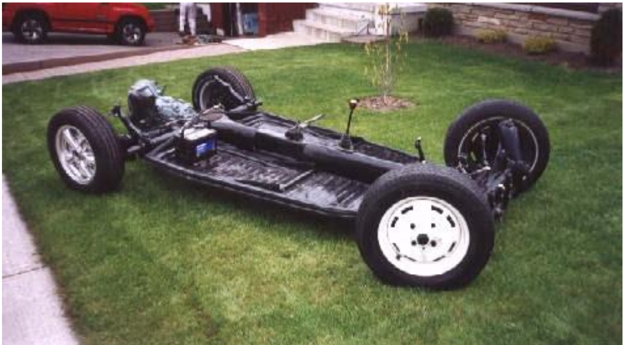
Εικόνα 2.9: Το πλαίσιο του VW Beetle 1ης γενιάς
