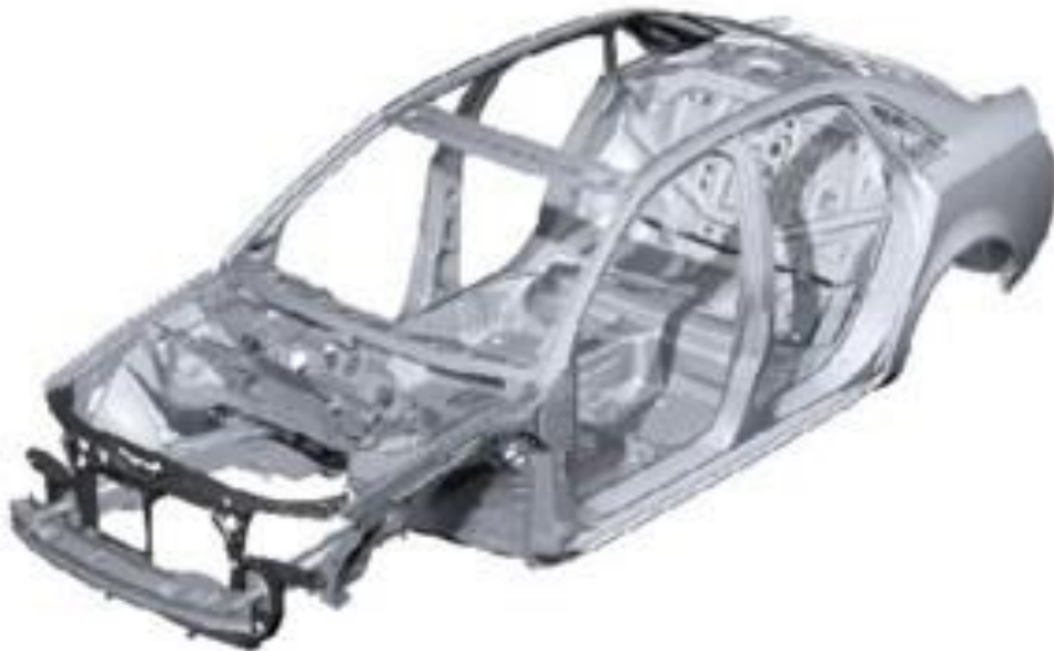
Εικόνα 2.12: Σύγχρονο αυτοφερόμενο πλαίσιο
