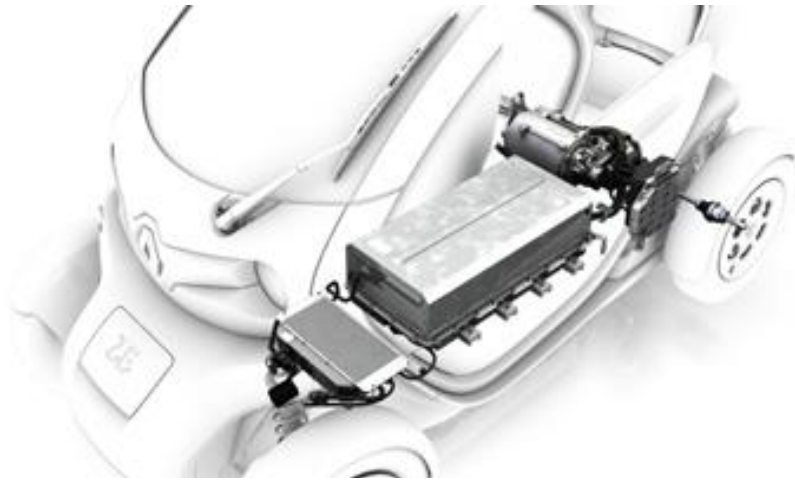
Εικόνα 2.26: Σύνολο μπαταρίας-κινητήρας-κιβώτιο ταχυτήτων του Renault Twizy
