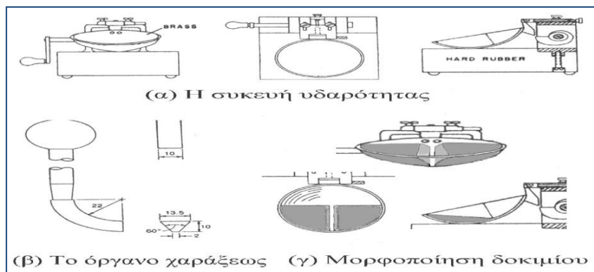
Σχήμα 2.13 Συσκευή υδαρότητας, όργανο χαράξεως και μορφοποίηση δοκιμίου.
