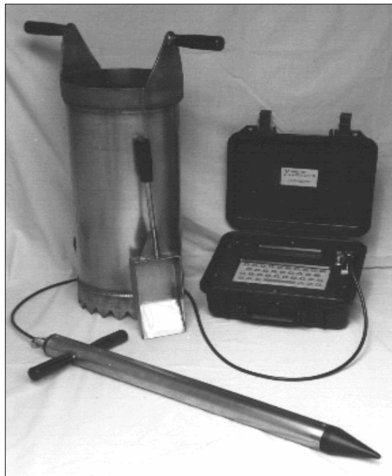
Σχήμα 2.4: Φορητό σύστημα μέτρησης της φυσικής ραδιενέργειας του λιγνίτη.
