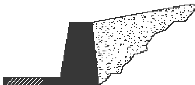
Σχήμα 1.3: Τυπική διατομή τοίχου βαρύτητας.
