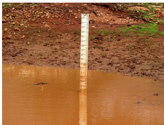
Εικόνα 4.3. Η ξύλινη σταδία που εγκαταστάθηκε στα λιμνία για την παρατήρηση της στάθμης του νερού σε αυτά.
