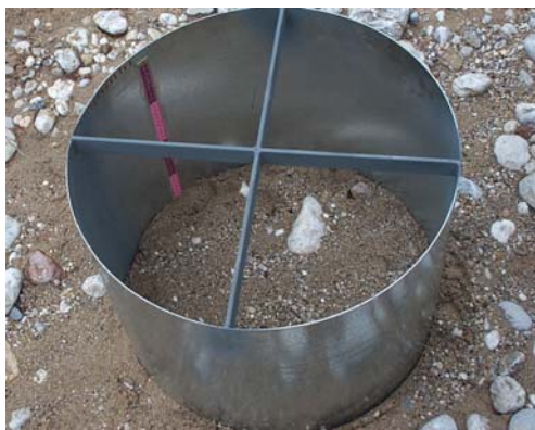
Εικόνα 4.4. Η κυλινδρική συσκευή που χρησιμοποιήθηκε στα πειράματα προσδιορισμού της διηθητικής ικανότητας του ιζήματος.
