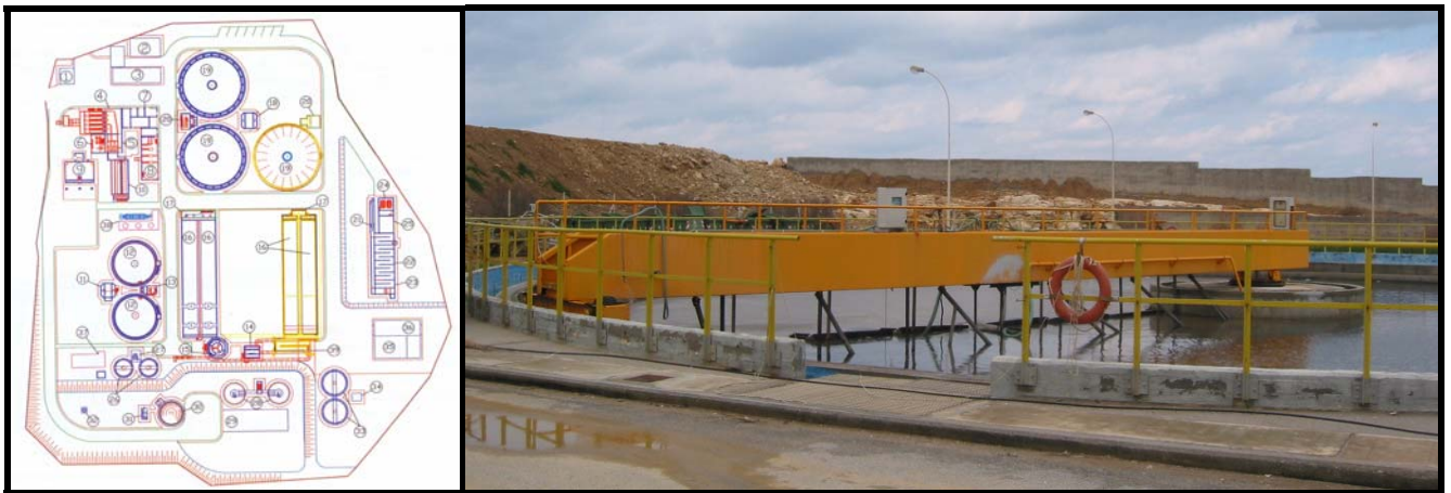
Εικόνα 4-1: Εγκατάσταση επεξεργασίας λυμάτων Δήμου Χανίων (αριστερά) όπου στο πάνω μέρος της κάτοψης διακρίνονται οι 3 δεξαμενές δευτεροβάθμιας καθίζησης και μια από τις δεξαμενές απ' όπου πάρθηκαν τα δείγματα (δεξιά).
