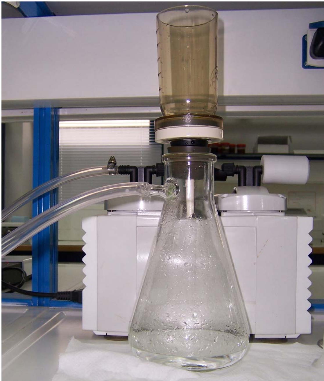
Εικόνα 4-7: Συσκευή διήθησης (μπροστά) και ηλεκτρική αντλία κενού (πίσω).
