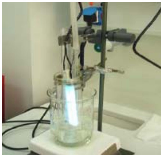
Εικόνα 4-4: Πειραματική διάταξη φωτοκατάλυσης (πριν καλυφτεί το δοχείο με αλουμινόχαρτο,) όπου διακρίνεται η λάμπα UVA και το σωληνάριο αερισμού.
