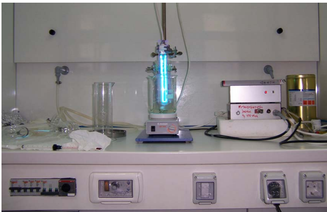
Εικόνα 4-5: Πειραματική διάταξη απολύμανσης με UVC μέσα στον απαγωγό του εργαστηρίου, δεξιά είναι ο μετασχηματιστής και στο κέντρο φαίνεται η λάμπα ατμών Hg όπου παράγει υπεριώδη ακτινοβολία UVC.
