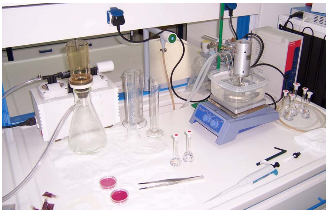
Εικόνα 4-2: Πειραματική διάταξη της γεννήτριας υπερήχων των 80 kHz.
