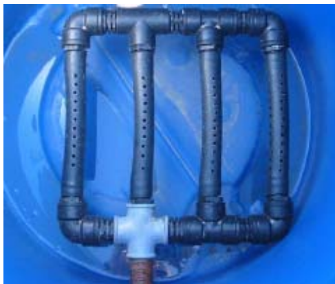
Σχήμα 3.3 – Σύστημα αποστράγγισης.
