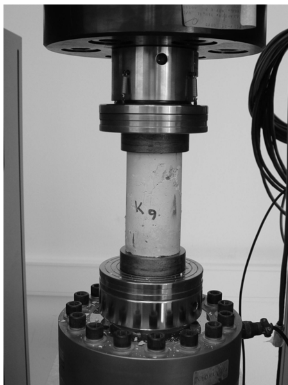
Σχήμα 7.8: Δοκιμή αντοχής σε θλίψη.
