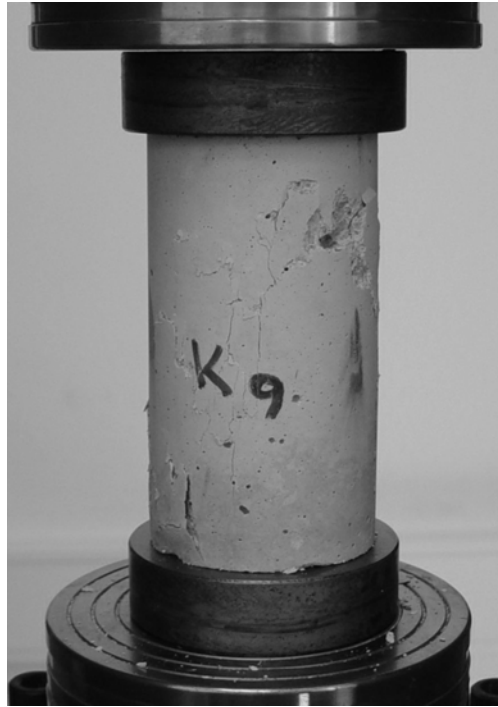
Σχήμα 8.4: Δοκίμιο K-9 σε δοκιμή θλίψης μετά από 120 κύκλους γήρανσης.
