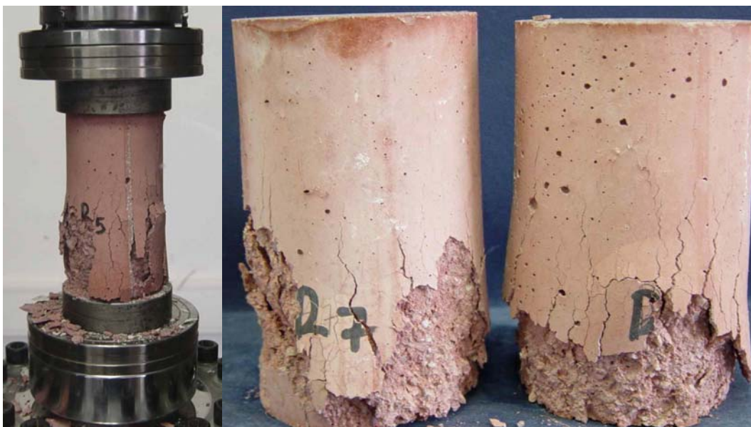
Σχήμα 8.3: Αριστερά δοκίμιο μετά από 50 κύκλους, δεξιά δοκίμιο μετά από 25 κύκλους και αφού έχουν υποστεί δοκιμή θλίψης. Παρατηρείται έντονη η αστοχία των υλικών στις κάτω βάσεις.
