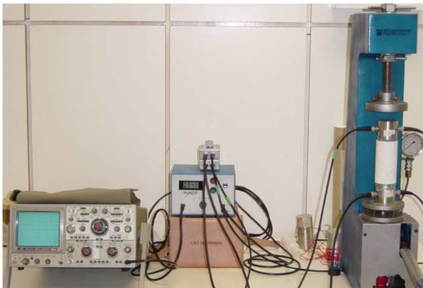
Σχήμα 5.9: Πειραματική διάταξη μέτρησης υπερήχων
