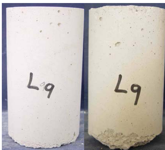
Σχήμα 8.1: Αριστερά το δοκίμιο μετά από 75 κύκλους και αριστερά μετά από 200 κύκλους.
