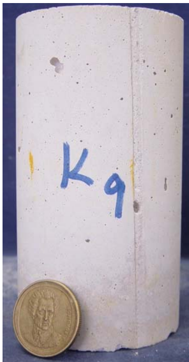
Σχήμα 6.5: Κυλινδρικό δοκίμιο από το ίδιο υλικό που παρασκευάζονται τα προς κατανάλωση πλακίδια.
