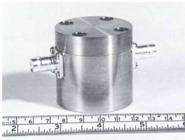
Σχήμα 7.3: Πομπός/δέκτης κυμάτων P και S.
