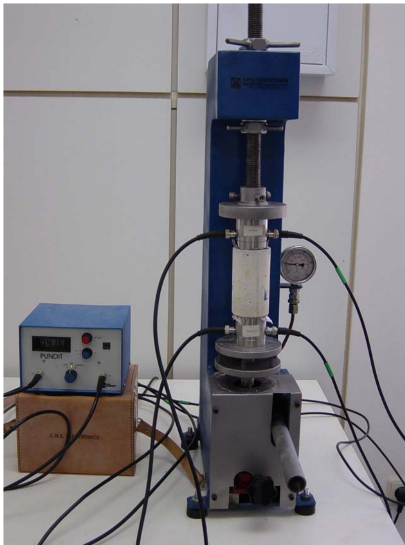
Σχήμα 7.5: Τοποθέτηση δοκιμίου στη πρέσα για μέτρηση των υπερήχων.
