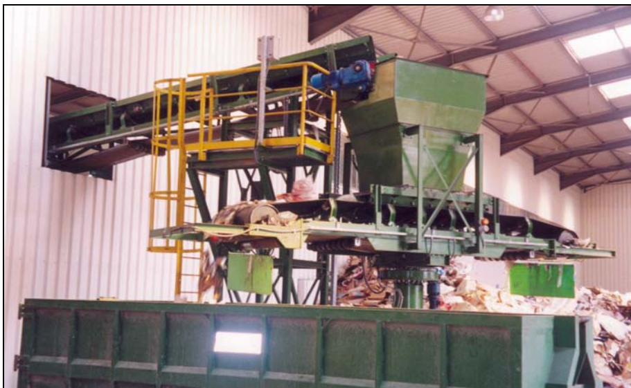
Εικόνα 8.10: Έξοδος διαχωρισμένων υλικών
