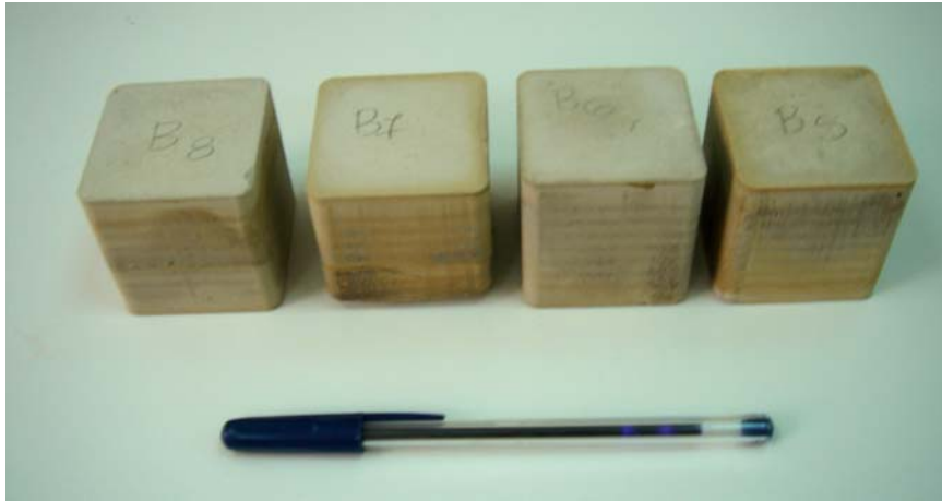
Σχήμα 4.2: Δοκίμια γεωπολυμερών μετά από χρόνο γήρανσης 7 ημερών.
