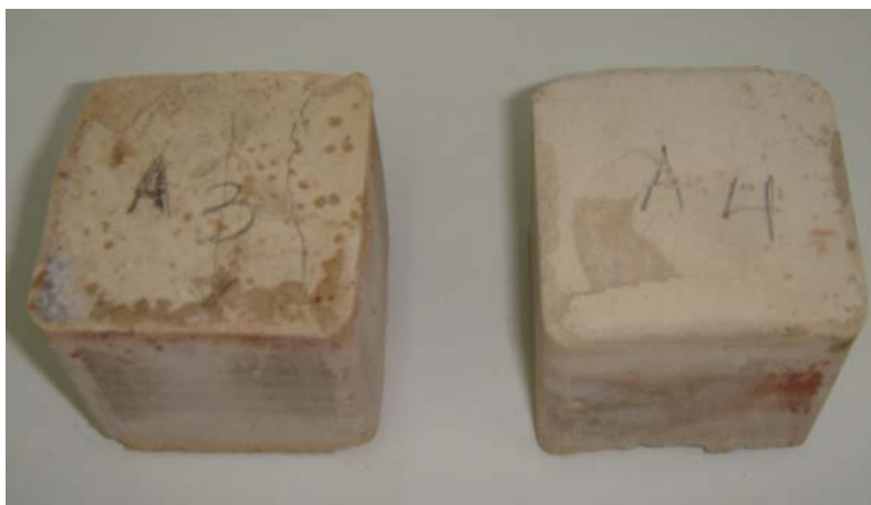
Σχήμα 5.3: Δοκίμια γεωπολυμερών μετά από θραύση.
