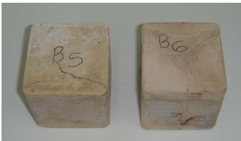
Σχήμα 5.2: Δοκίμια γεωπολυμερών μετά από θραύση.
