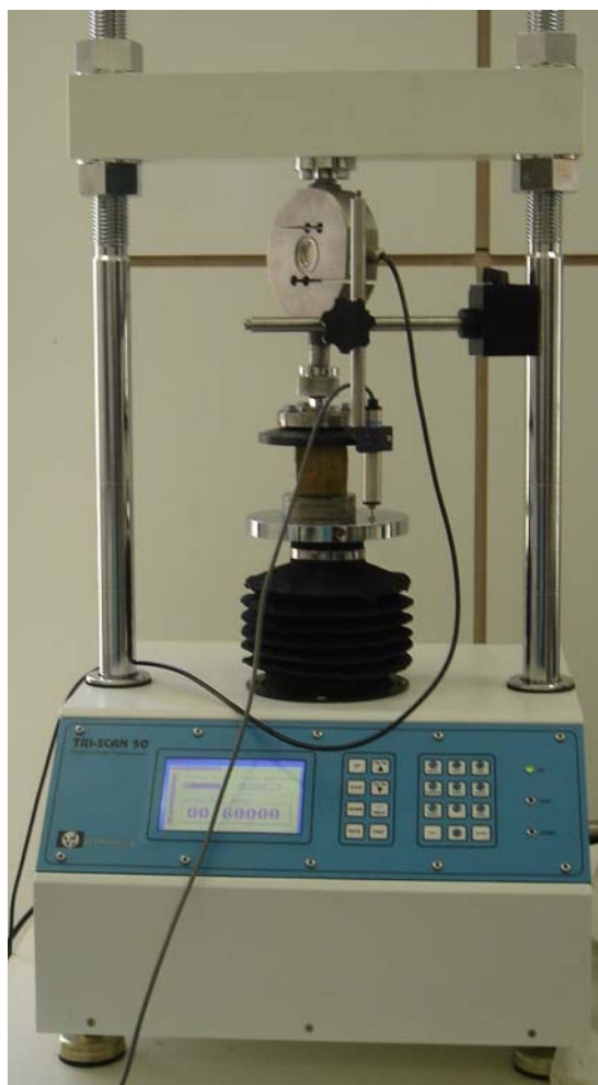
Σχήμα 5.1: Μηχανή φόρτισης TRI-SCAN 50.
