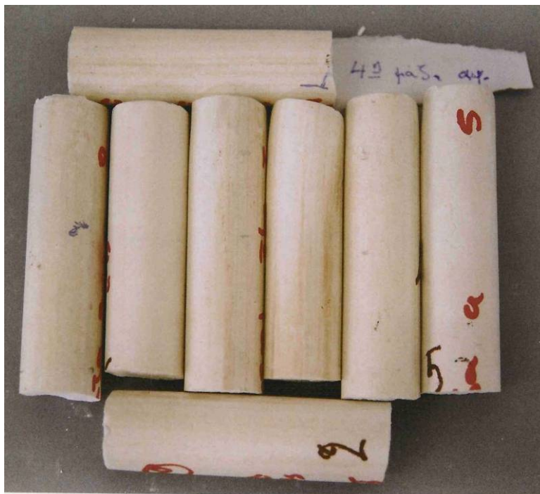
Εικόνα III.4.14: Εξωτερική ποιότητα των δειγμάτων με συνδυασμό των 2 συχνοτήτων, με χαμηλή εφαρμοζόμενη ισχύ για τη χαμηλή συχνότητα και υψηλή εφαρμοζόμενη ισχύ για την υψηλή συχνότητα, τρία περάσματα και χρόνο παραμονής 2,45 min.
