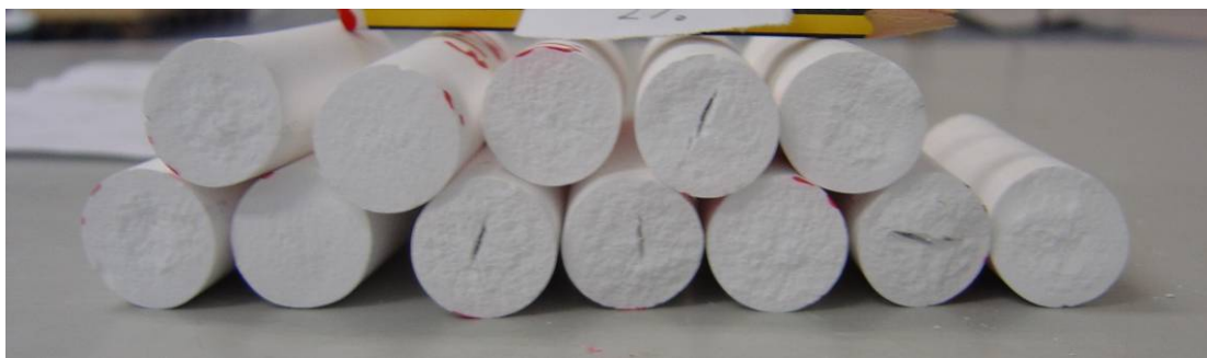
Εικόνα III.4.22: Εσωτερική ποιότητα των δειγμάτων για χρόνο περάσματος 4,11 min, διάμετρο δοκιμίων 4 εκατοστά και 3 περάσματα.
