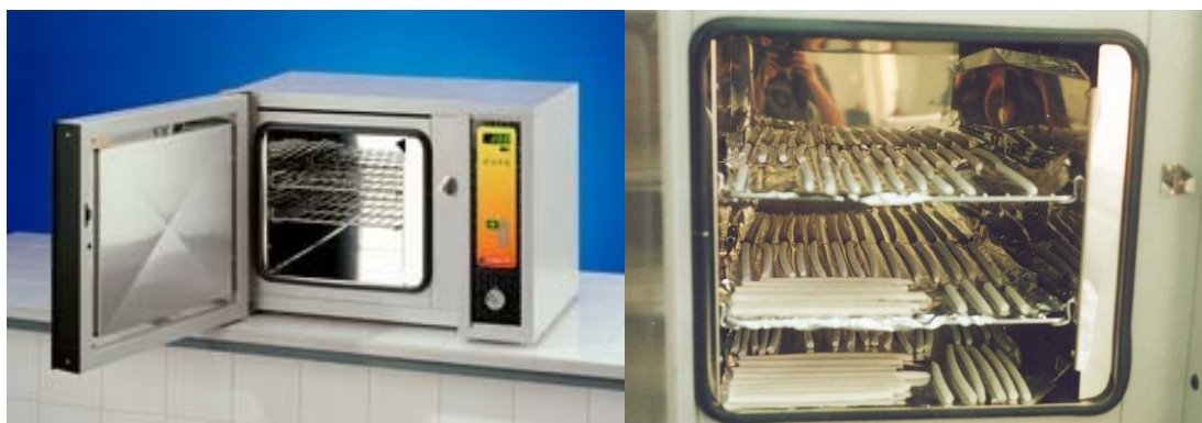
Εικόνα II.3.3.1: Ξήρανση των δοκιμίων στο πυριαντήριο, σταδιακά από τους 50 μέχρι και τους 110°C.
