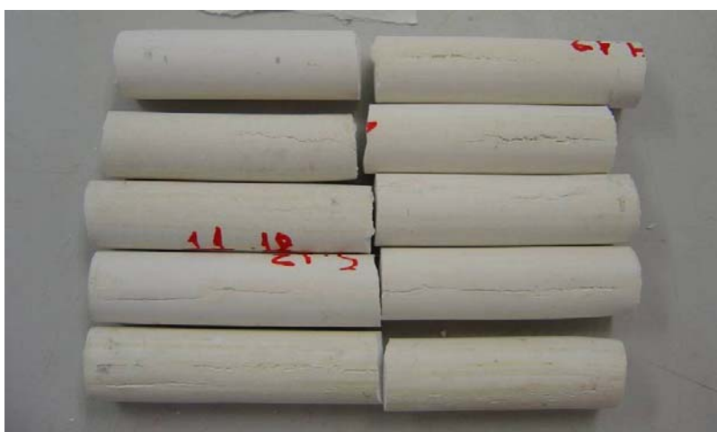
Εικόνα III.4.8: Εξωτερική ποιότητα των δειγμάτων με συνδυασμό των 2 συχνοτήτων με χαμηλή εφαρμοζόμενη ισχύ για τη χαμηλή συχνότητα και υψηλή εφαρμοζόμενη ισχύ για την υψηλή συχνότητα και χρόνο παραμονής 3,52 min.
