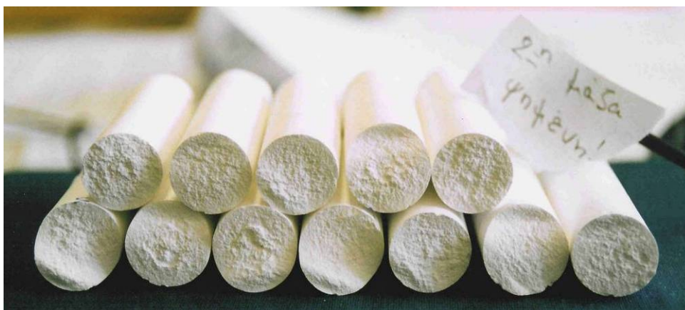
Εικόνα III.4.5: Εσωτερική ποιότητα των δειγμάτων για συχνότητα μικροκυμάτων 5,8 GHz με μέση-υψηλή εφαρμοζόμενη ισχύ.
