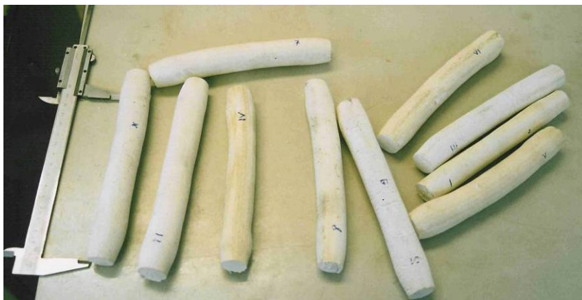
Εικόνα III.4.3: Εξωτερική ποιότητα των δειγμάτων για μέγιστη ισχύ μικροκυμάτων
