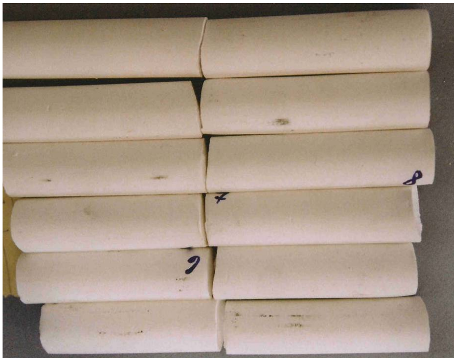
Εικόνα III.4.18: Εξωτερική ποιότητα των δειγμάτων για χρόνο περάσματος 2,45 min, διάμετρο δοκιμίων 3 εκατοστά και 3 περάσματα.
