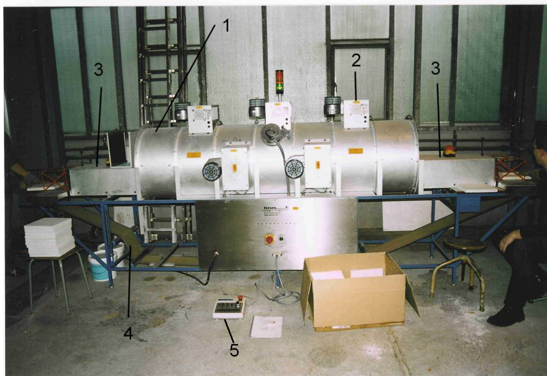
Εικόνα II.3.3.1.1: Πολυσυχνοτικό σύστημα (multi-mode) ξήρανσης μέσω μικροκυμάτων MDBT 4,8-2,4 της εταιρείας Linn High Therm GmbH.
