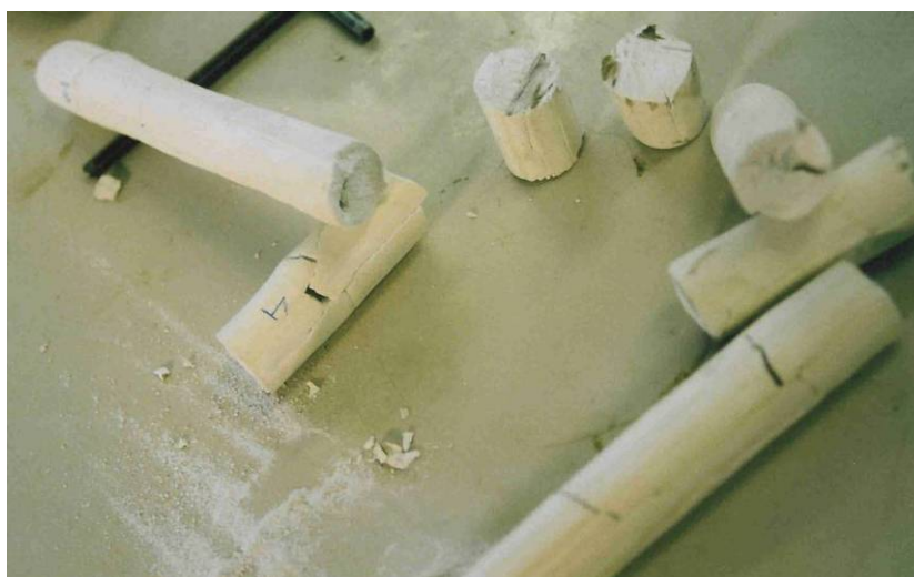
Εικόνα III.4.4: Εξωτερική και εσωτερική ποιότητα των δειγμάτων για συχνότητα μικροκυμάτων 2,45 GHz με μέση-χαμηλή εφαρμοζόμενη ισχύ
