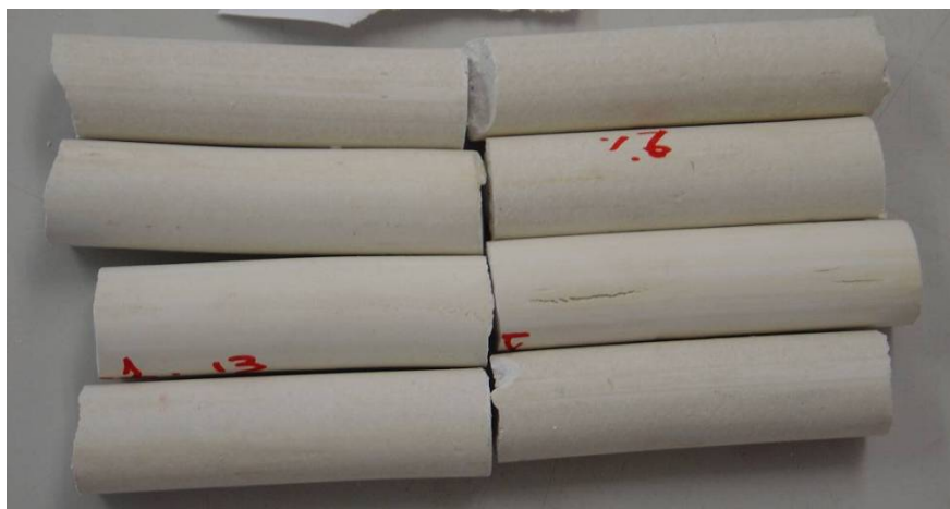
Εικόνα III.4.10: Εξωτερική ποιότητα των δειγμάτων με συνδυασμό των 2 συχνοτήτων με χαμηλή εφαρμοζόμενη ισχύ για τη χαμηλή συχνότητα και υψηλή εφαρμοζόμενη ισχύ για την υψηλή συχνότητα και χρόνο παραμονής 3,11 min.
