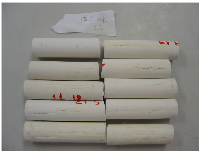
Εικόνα II.3.3.3.1: Δοκίμια που έχουν ξηρανθεί με μικροκύματα και κατά τη διάρκεια της ξήρανσης έχουν εμφανιστεί ρωγμές κατά μήκος τους.
