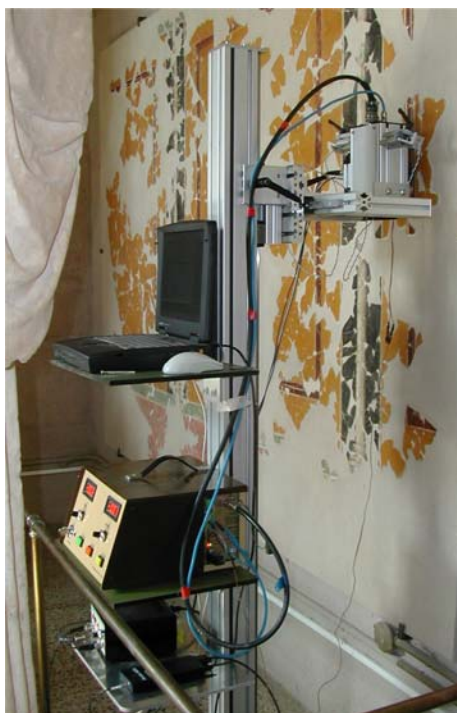
Εικόνα 9.1: Ανάλυση τοιχογραφίας με φορητό φασματόμετρο ακτίνων-Χ.
