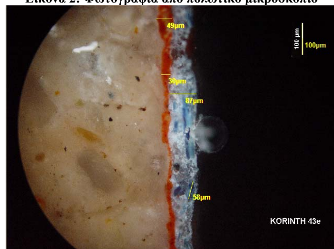
Εικόνα 3: Φωτογραφία από πολωτικό μικροσκόπιο που έχει αναλυθεί με τη βοήθεια του προγράμματος Image Pro Plus
