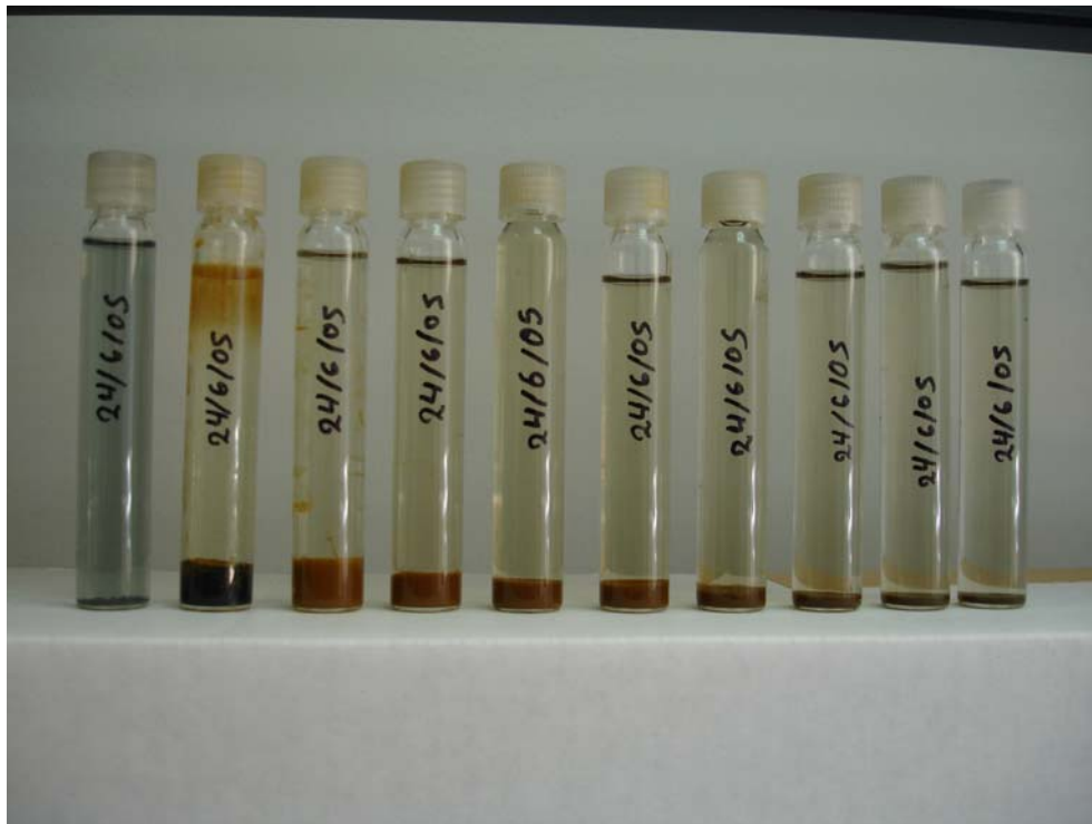
Εικόνα 8.3.: Δείγματα από τα πειράματα ηλεκτρόλυσης του πραγματικού αποβλήτου με προσθήκη 3,5% \text{FeSO}_4 , ως ηλεκτρολύτη, και 20A.
