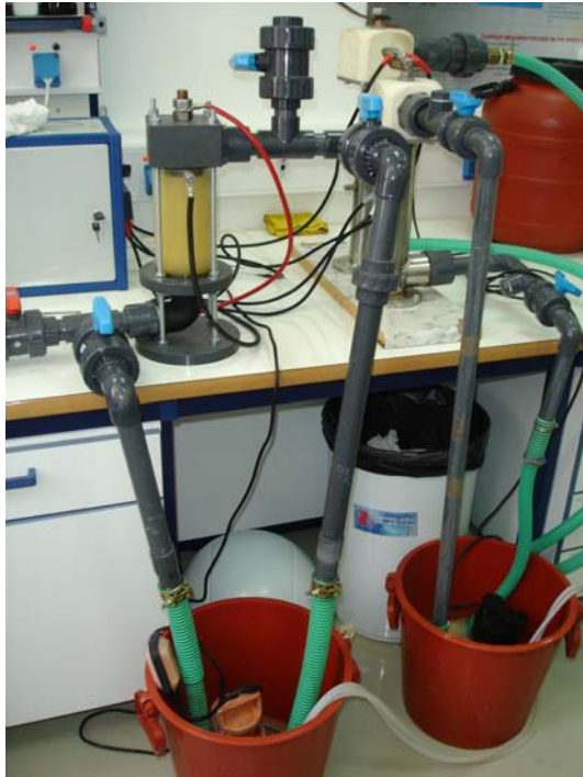
Εικόνα 8.1.: Φωτογραφία της πειραματικής διάταξης ηλεκτρόλυσης που χρησιμοποιήθηκε.
