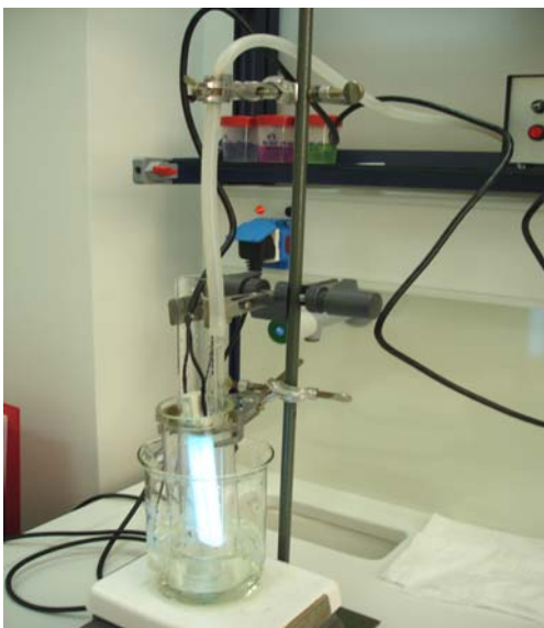
Εικόνα 5.4.: Πειραματική διάταξη φωτοκατάλυσης.
