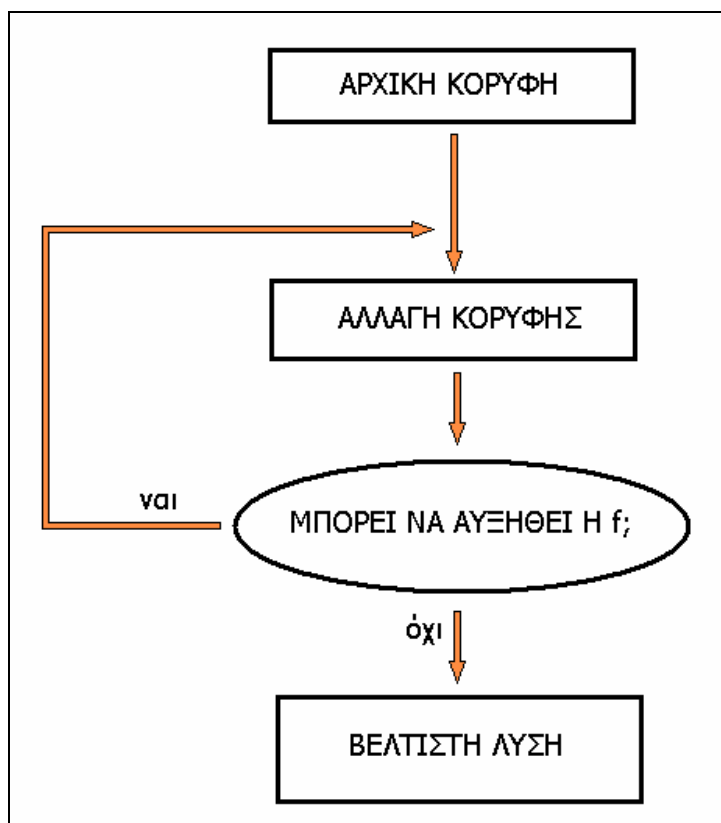
Σχήμα 4.12: Η αρχή λειτουργίας της μεθόδου Simplex [8], [9]
