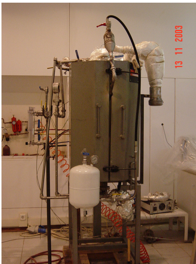
Εικόνα 3.2 Πειραματική διάταξη συστήματος ρευστοποιημένης κλίνης που χρησιμοποιήθηκε στη παρούσα εργασία.
