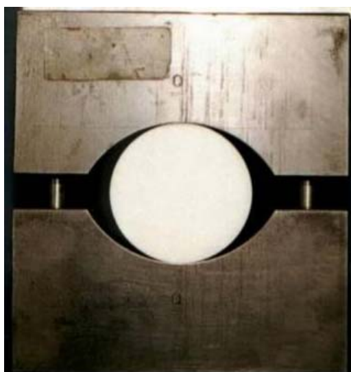
Σχήμα 1.2: Διάταξη δοκιμής Βραζιλιανού δίσκου
