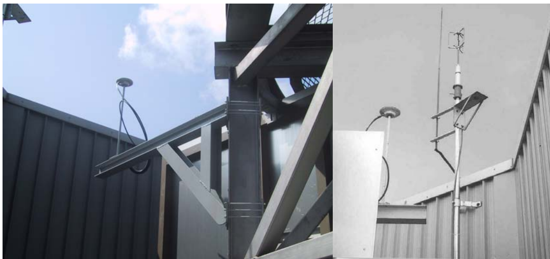
Σχήμα 5.3: Οι κεραίες GPS και τα ανεμόμετρα στην ταράτσα του RPB
