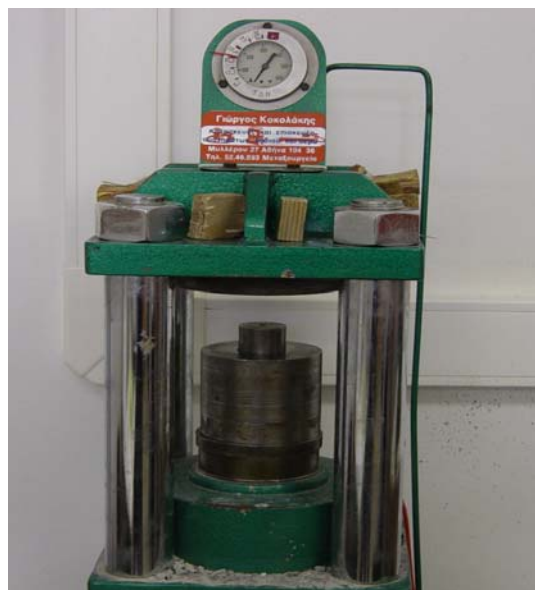
Εικόνα 5.3. Πρέσα για τη συμπίεση των δοκιμίων.
