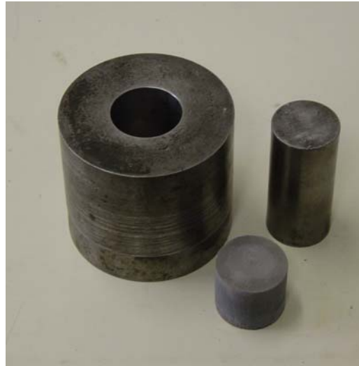
Εικόνα 5.2. Καλούπι για την παρασκευή των δοκιμίων.
