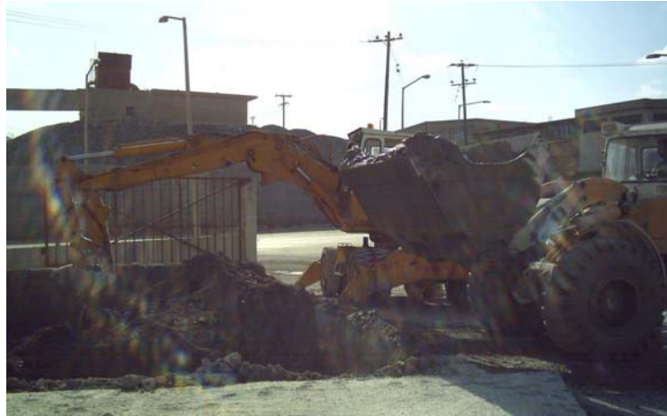
Εικόνα 3.6. Κεκλιμένο επίπεδο συγκέντρωσης και διαβροχής της παιπάλης για τη μεταφορά της από φορτωτές.
