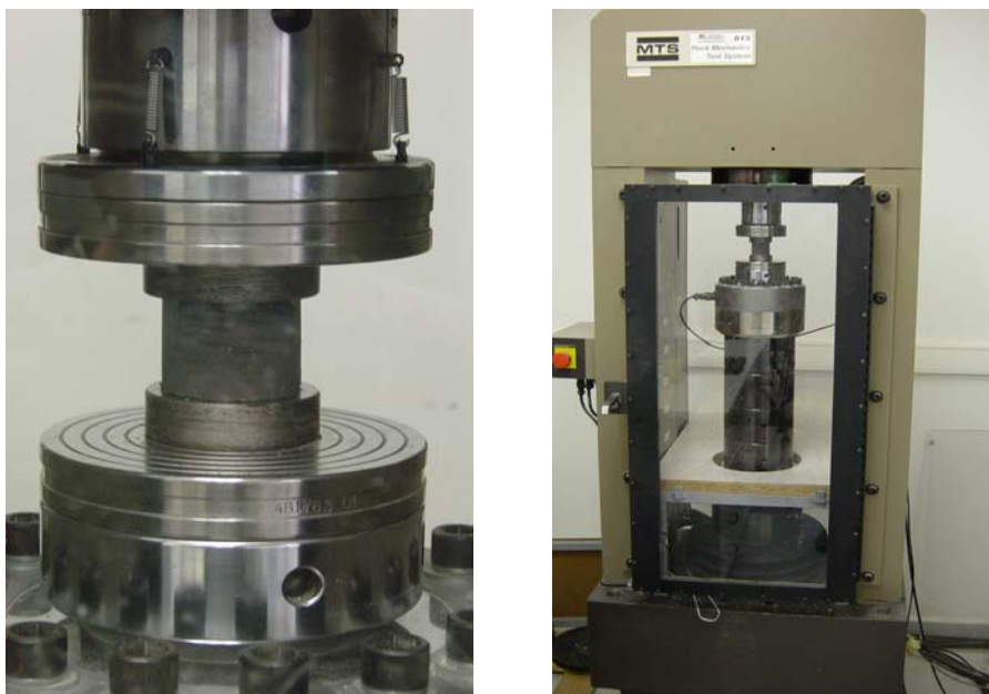
Εικόνα 5.5. Η μηχανή MTS 1380 και δοκίμιο.
