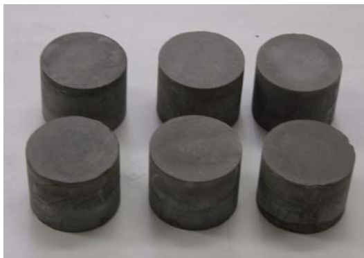
Εικόνα 5.4. Δοκίμια όπως εξάγονται από το καλούπι μετά τη συμπίεση.
