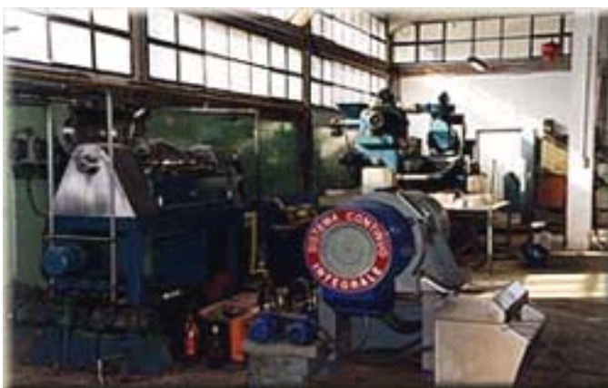
Σχήμα 1.6 Φυγοκεντρικό ελαιουργείο τριών φάσεων
