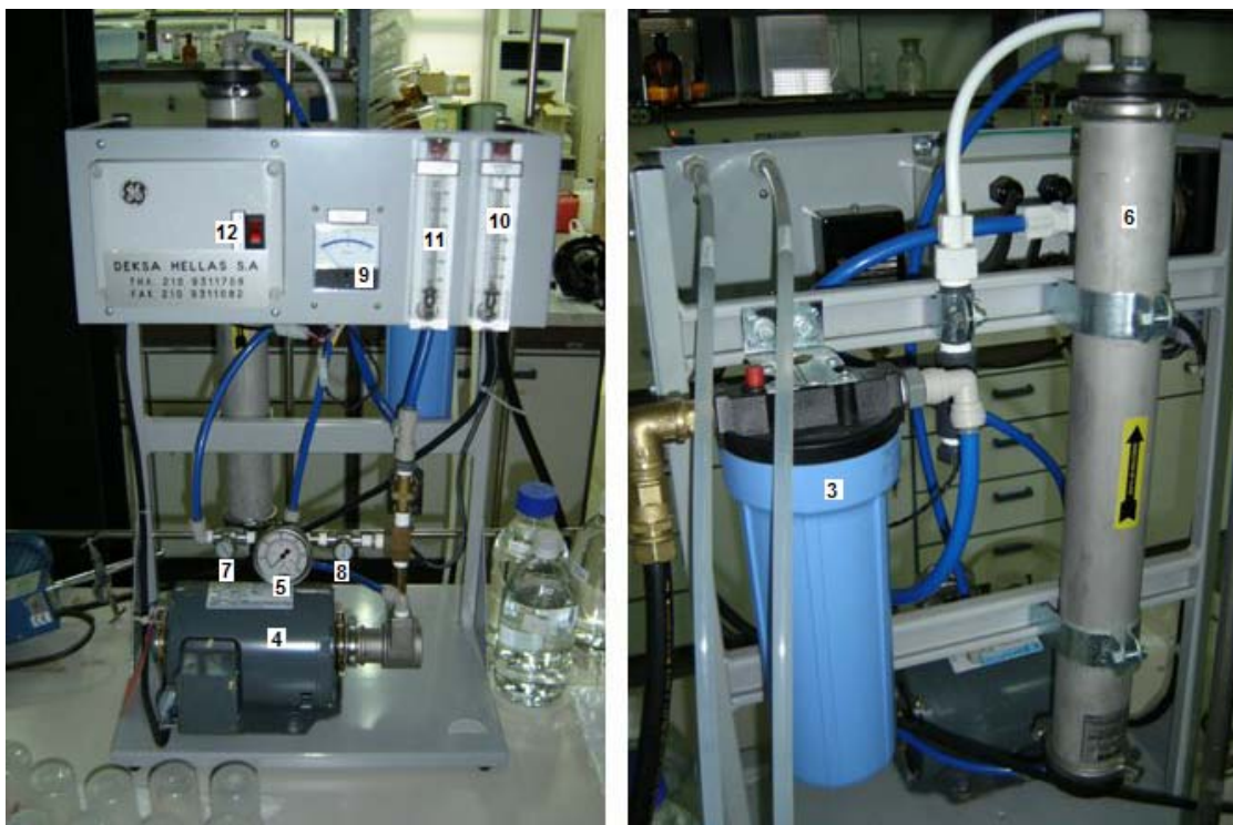
Φωτογραφία 3.1: Η μπροστινή και η πίσω όψη της εργαστηριακής εγκατάστασης RO.
